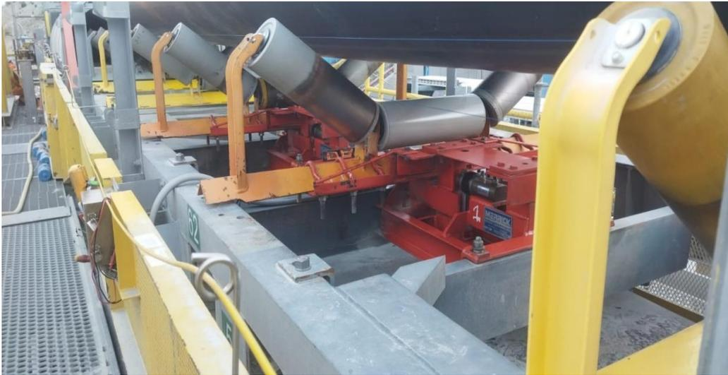
*Nota.* En la figura 9, se puede apreciar dos módulos de pesaje modelo 471 en la marca Merrick las cuales vienen del área Pebbles (circuito cerrado que retroalimenta a los molinos SAG) mediante la alimentación de las fajas de sacrificio para molinos SAG en LAS BAMBAS. Fuente: Rts Automation SAC.
