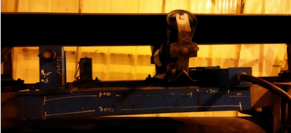
*Nota.* En la siguiente figura se aprecia las medidas que ingresarán al controlador, las cuales tienen que ser analizadas por el supervisor Instrumentista para una calibración correcta. Fuente: Elaboración propia.
