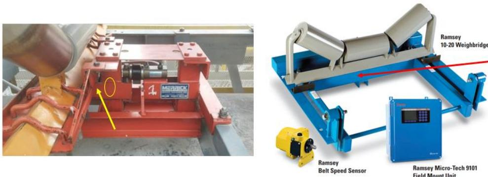
*Nota.* La posición de estos sensores de vibración es tomando las consideraciones para posmantenimiento (no afectaría en los cronogramas de mantenimiento de la unidad minera). En ambas marcas los sensores van internamente de la estructura con el fin de que no sean dañados por el material que transporta la faja. Fuente: Elaboración propia.
