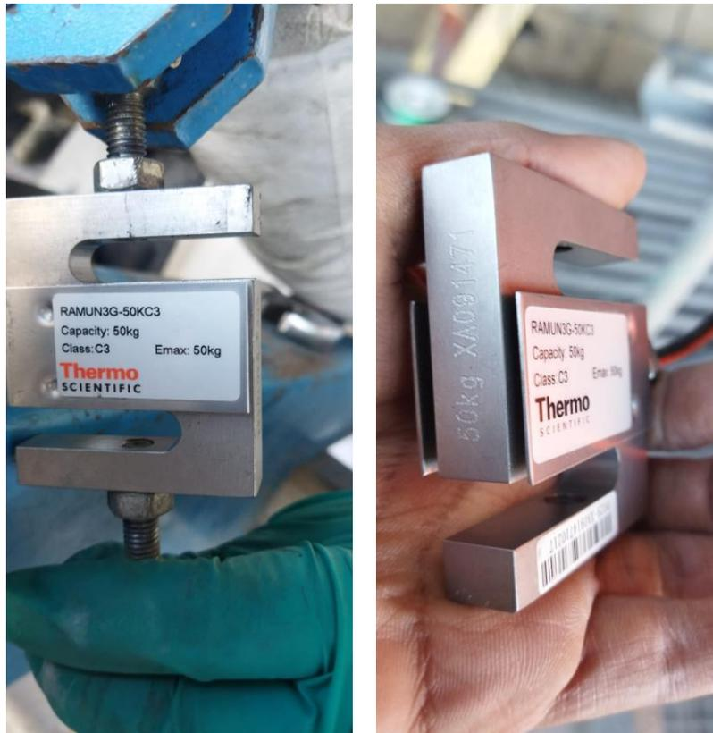
*Nota.* La capacidad de las celdas de carga son de 50 Kg cada una, dando una capacidad total de 100 kg de carga (peso del módulo + diseño de flujo). Fuente: Elaboración propia.
