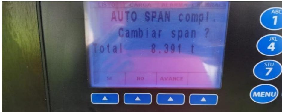
*Nota.* En la imagen capturada del integrado se puede apreciar una diferencia de 2 kg con referencia al ConCal teórico ya calculado anteriormente. Fuente: Elaboración propia.
