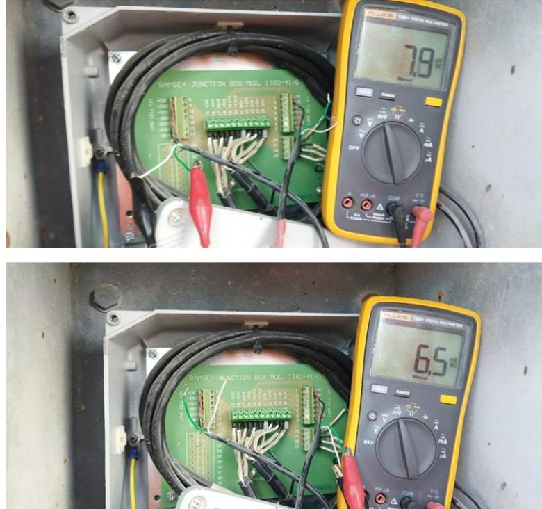
*Nota.* El balanceo de celdas tiene que tener el mismo valor. Este sistema pivotante tiene dos celdas de carga que, si no están balanceadas en el orden de los milivoltios, se verán afectadas mecánicamente, una de ellas estaría asumiendo gran parte de la carga (Diseño de flujo de carga). Fuente: Elaboración propia.
