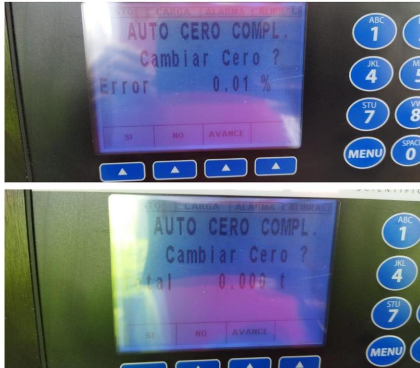
*Nota.* En la figura se aprecia el porcentaje de error capturado para esta calibración (0.01%). Fuente: Elaboración propia.
