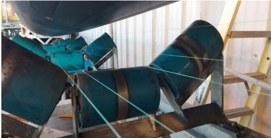
*Nota.* En la figura 18, se visualiza la nivelación de los polines centrales y laterales.
