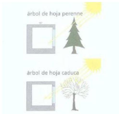
Ilustración 13: Tipos de Vegetación para el control de la incidencia solar. Fuente: Estrategias de Confort Térmico (UTPL)
