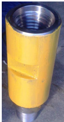
Figura 31: Metalizado: Recuperación de barras de Perforación – Varillaje
