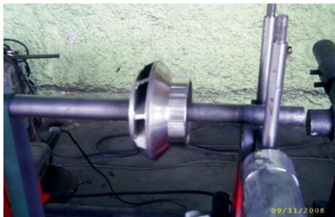
Figura 28: Reparación de Bombas Sumergibles
