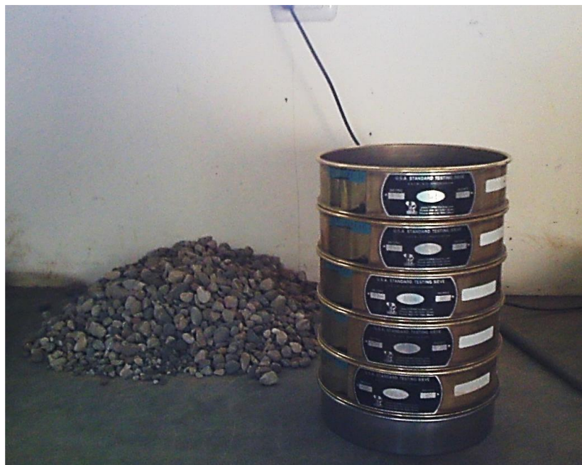
Gráfico 7: Agregado y tamices 1", 3/4", 1/2", 3/8" y #4 para ensayo de granulometría
