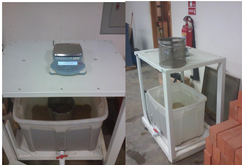
Gráfico 8: Peso específico del agregado.
