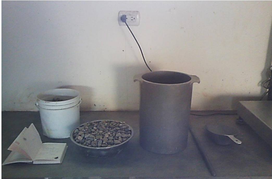
Gráfico 9: Agregado y recipiente para determinar el peso unitario del agregado.
