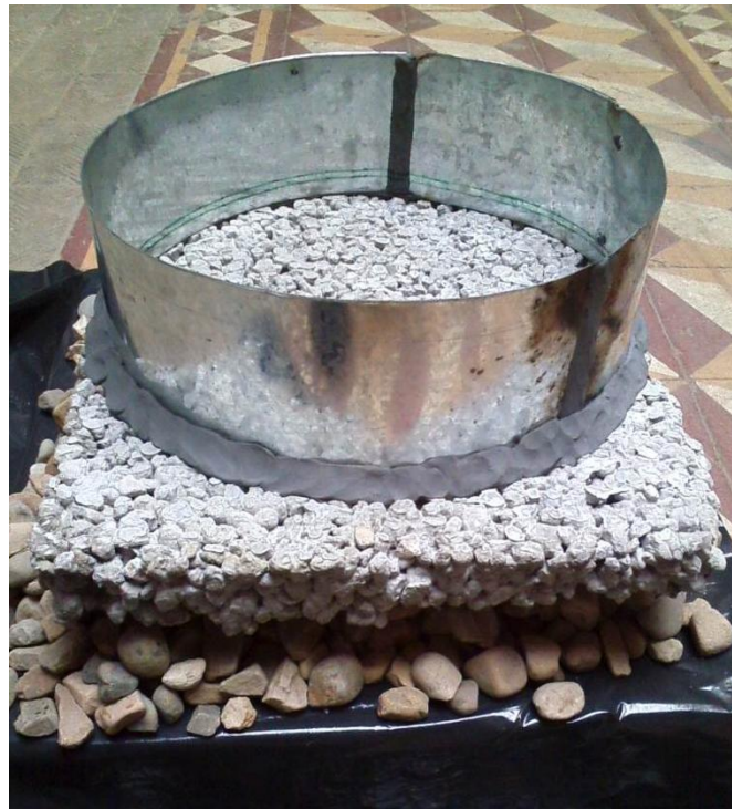
Gráfico 45: Ensayo de infiltración ASTM C 1701.
