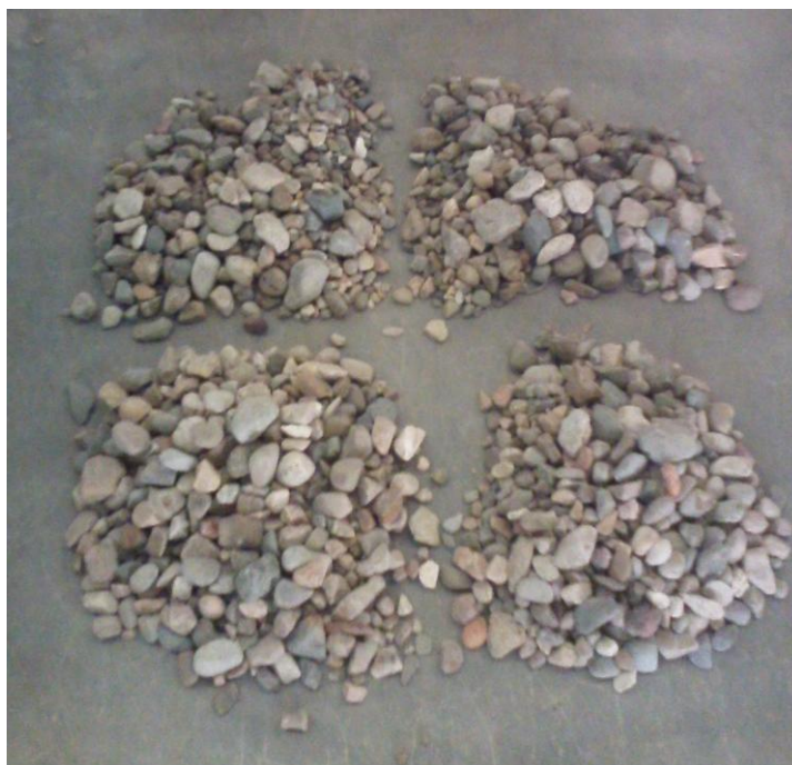
Gráfico 4: Cuarteo de agregados
