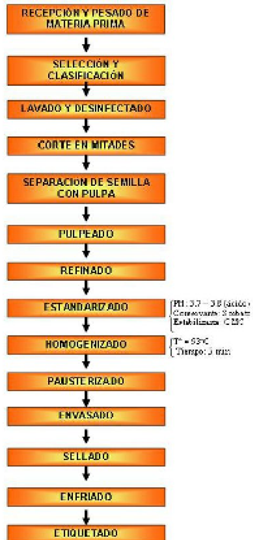
Diagrama de flujo del proceso de producción del néctar de granadilla.
