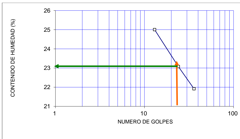
Figura N° 7.16. Límites de consistencia - calicata N° 01.
