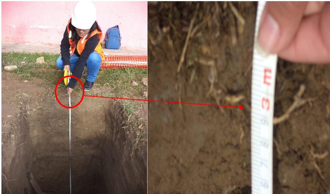
Figura N° 7.22. Calicata N°02, profundidad 3.00m.
