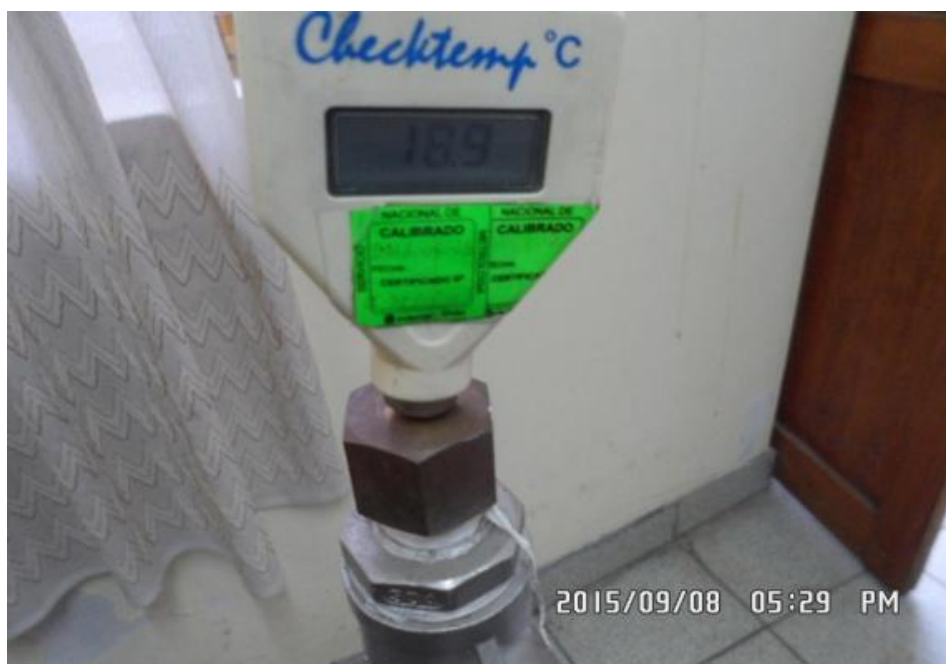
Termómetro, controla la temperatura al ingresar el agua por los medidores
