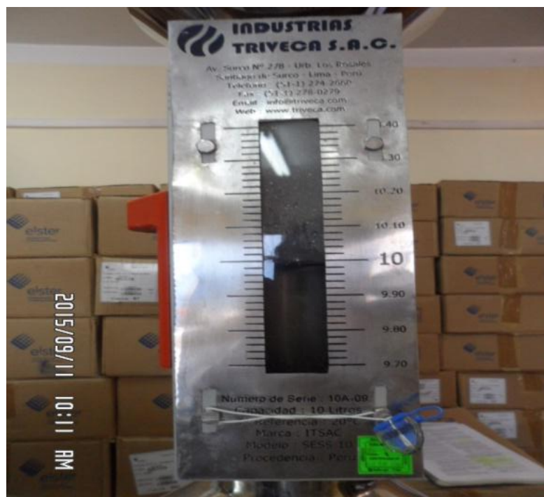
Regleta de Medidor volumétrico patrón, de acero inoxidable
