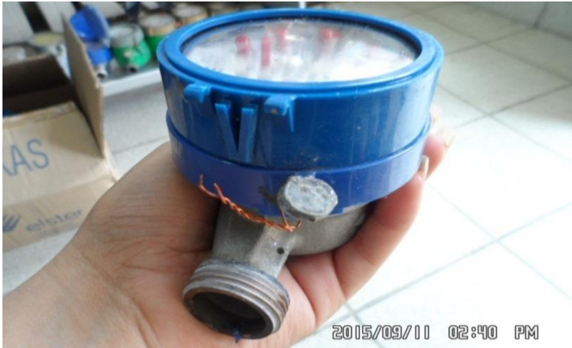
Medidor con precinto de seguridad roto.
