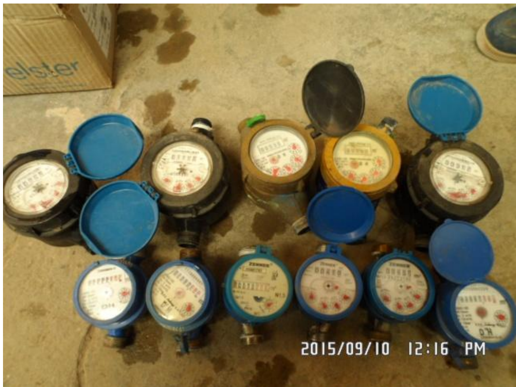
Medidores retirados y llevados al laboratorio para su prueba de contrastación.
