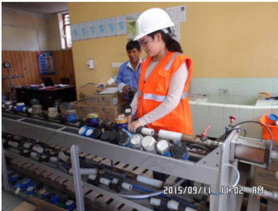
Colocación de medidores en el banco, teniendo en cuenta la dirección del flujo.
