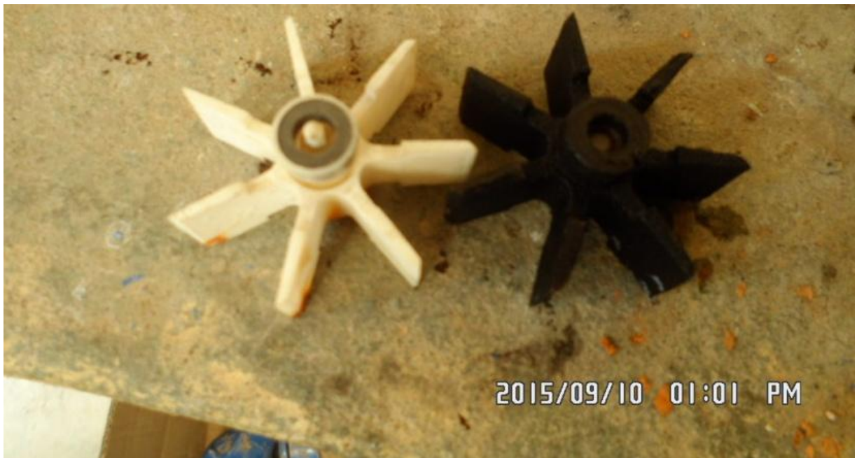
Medidor con pistón roto, a causa de su antigüedad.
