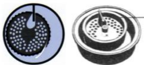
Imagen N° 05: Funcionamiento de un medidor de Pistón Oscilante
