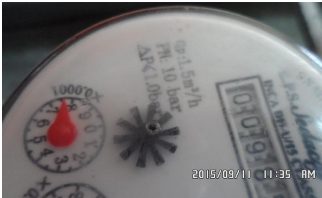
Medidor con luneta perforada con aguja.
