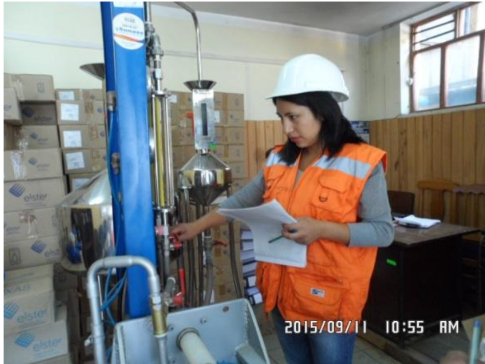
Manipulación de los rotámetros para eliminar burbujas
