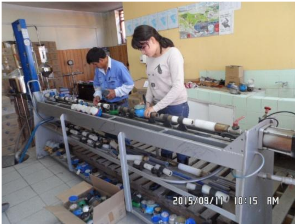
Al finalizar las pruebas, se retira los medidores y se coloca en una zona donde pueda escurrir el agua
