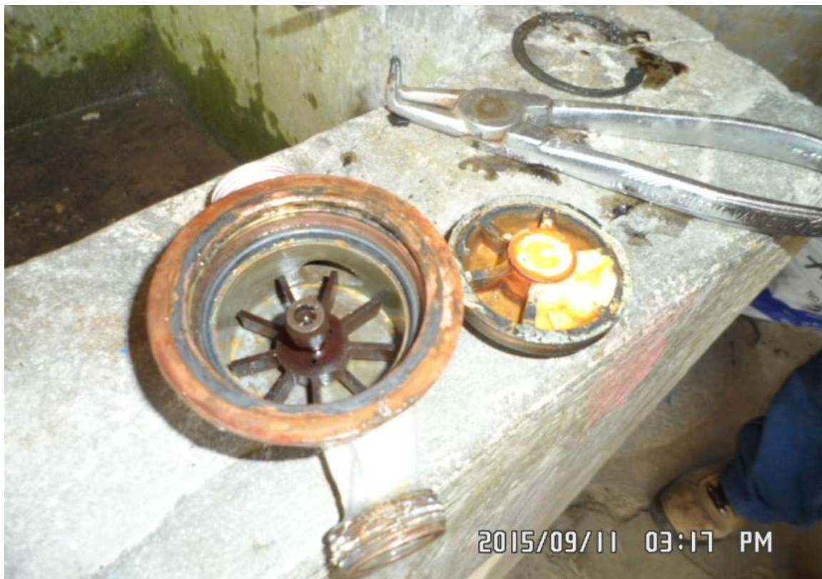
Medidor paralizado, se encuentra con óxido el mecanismo interno.
