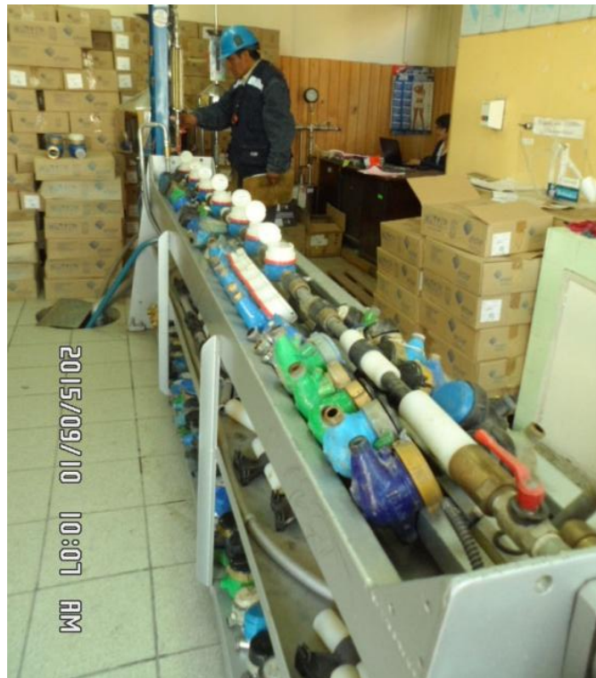
Prueba de medidores de clase R100, sólo ingresan siete medidores por prueba
