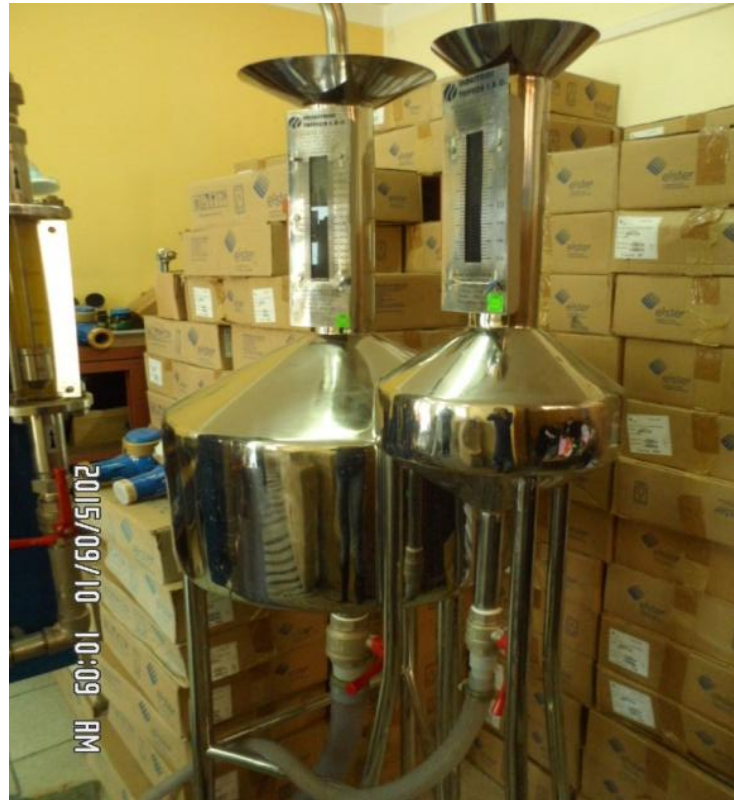
Medidor volumétrico patrón, de acero inoxidable
