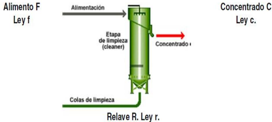
**Fig. N° 14 Balance circuito de flotación.**
