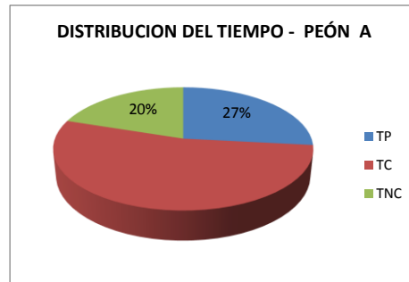
GRÁFICO N°45: Distribución del tiempo – Peón A en el proceso de asentado de muros de ladrillo vivienda 1
