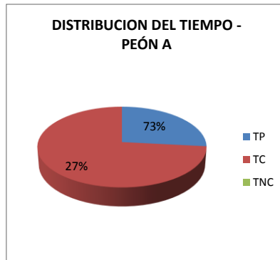
GRÁFICO N°49: Distribución De Trabajo – Peón A en el proceso en encofrado y vaciado de vigas de cimentación en la vivienda N° 02
