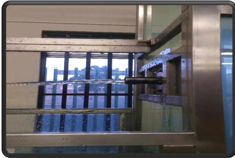
Fotografía 03: Orificio circular de pared delgada de forma circular
