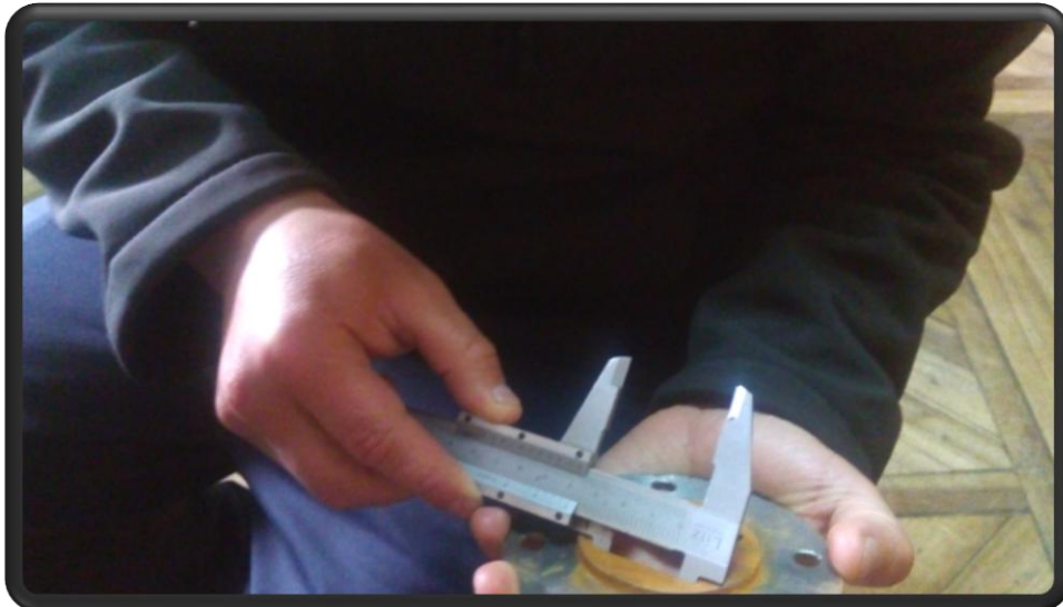
Fotografía 01: medición de dimensiones del accesorio (orificio cuadrado)
