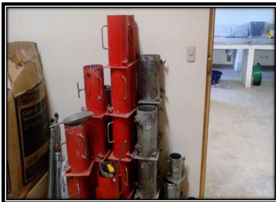
Fotografía N° 6: Almacenamiento de Moldes para probetas de concreto (Laboratorio de concreto)
