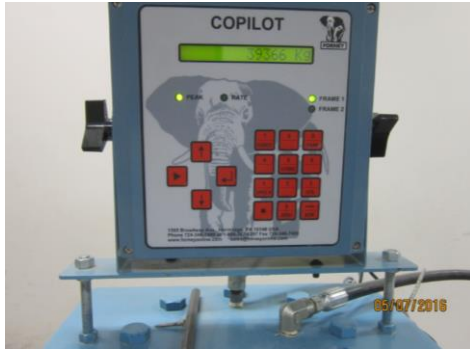
Figura N° 42: Se muestra la cantidad de carga que la probeta resistió, con este dato se determinó su resistencia a compresión.
