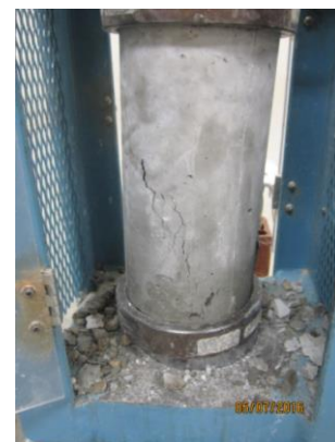
Figura N° 37: Se aprecian las micro fisuras en la parte inferior de la probeta.
