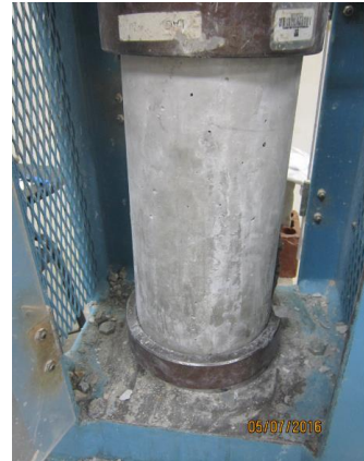
Figura N° 45: Se puede apreciar a la probeta de concreto en la máquina de compresión para ser ensayada.
