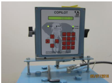
Figura N° 40: Se muestra la cantidad de carga que la probeta resistió, con este dato se determinó su resistencia a compresión.
