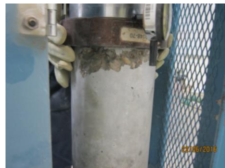
Figura N° 13: Se ve el tipo de falla que tuvo la probeta ensayada a compresión.
