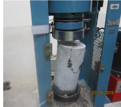
Figura N° 11: Se aprecia una probeta de concreto ensayada a compresión; también se ve el tipo de falla que este tuvo.
