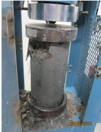
Figura N° 20: Se ve el tipo de falla que tuvo la probeta cuando fue ensayada a compresión.
