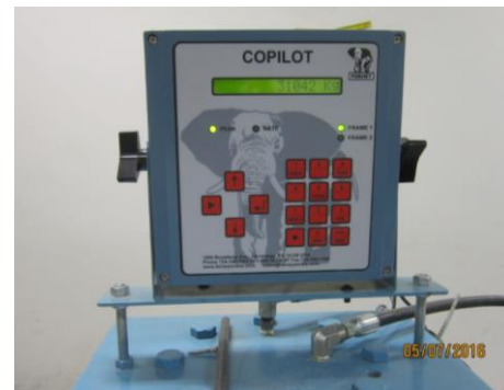
Figura N° 52: Se muestra la cantidad de carga que la probeta resistió, con este dato se determinó su resistencia a compresión.
