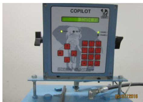
Figura N° 50: Se muestra la cantidad de carga que la probeta resistió, con este dato se determinó su resistencia a compresión.
