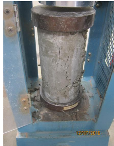
Figura N° 57: Se aprecian las fisuras en todas las partes de la probeta.
