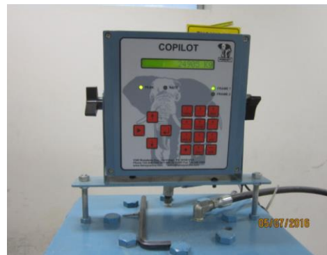
Figura N° 42: Se muestra la cantidad de carga que la probeta resistió, con este dato se determinó su resistencia a compresión.
