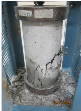
Figura N° 43: Se ve el tipo de falla que tuvo la probeta cuando fue ensayada a compresión.
