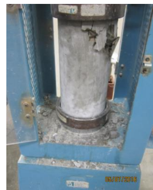
Figura N° 47: Se ve el tipo de falla que tuvo la probeta cuando fue ensayada a compresión.
