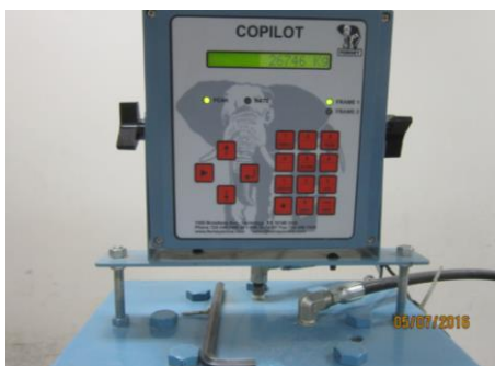
Figura N° 44: Se muestra la cantidad de carga que la probeta resistió, con este dato se determinó su resistencia a compresión.
