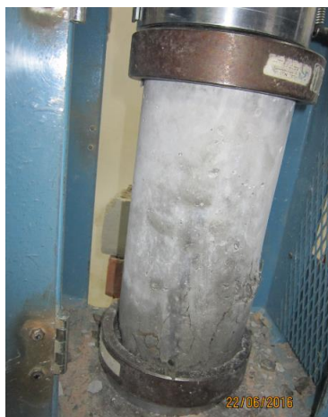
Figura N° 16: Se aprecian las micro fisuras en la parte inferior de la probeta.
