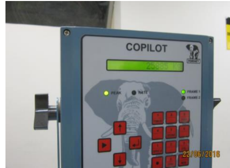
Figura N° 17: Se muestra la cantidad de carga que la probeta resistió, con este dato se determinó su resistencia a compresión.
