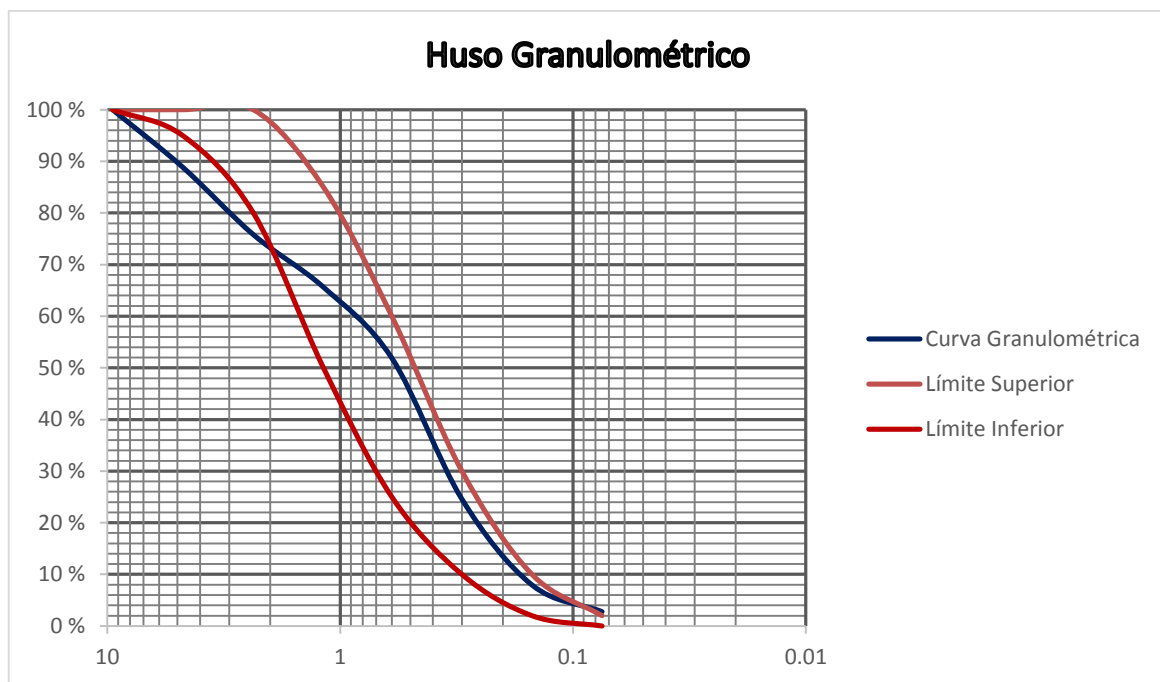
Figura N° 08: Huso granulométrico del agregado fino (huso 67)
