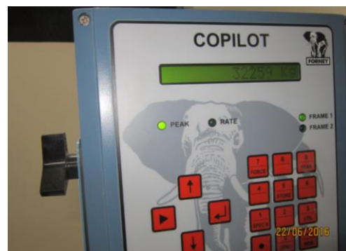
Figura N° 19: Se muestra la cantidad de carga que la probeta resistió, con este dato se determinó su resistencia a compresión.
