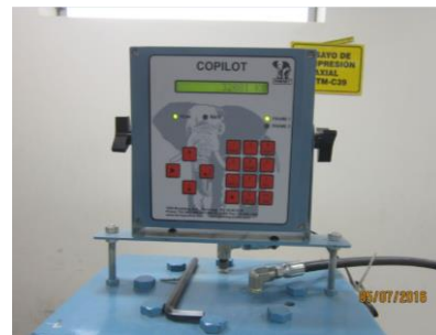
Figura N° 30: Se muestra la cantidad de carga que la probeta resistió, con este dato se determinó su resistencia a compresión.
