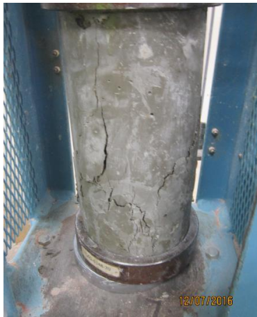
Figura N° 55: Se aprecian las fisuras en todas las partes de la probeta.
