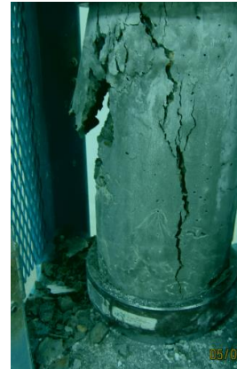
Figura N° 35: Se ve el tipo de falla que tuvo la probeta cuando fue ensayada a compresión.
