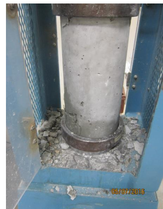
Figura N° 41: Se aprecian las fisuras en la parte inferior de la probeta.
