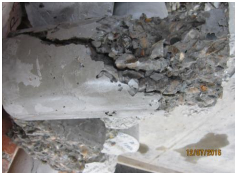
Figura N° 61: Se ve el colapso de la probeta al fallar totalmente.
