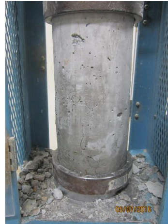
Figura N° 41: Se aprecian las microfisuras en la parte inferior de la probeta.
