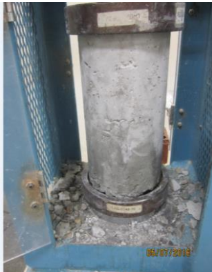
Figura N° 39: Se puede apreciar a la probeta de concreto en la máquina de compresión para ser ensayada.
