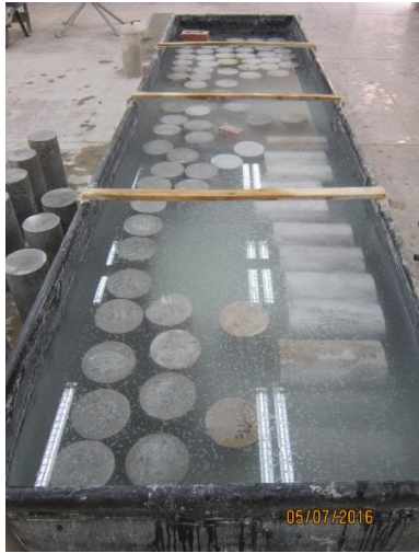
Figura N° 26: Se muestra la poza de curado de las probetas de concreto elaboradas, esperando a ser ensayadas.
