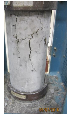
Figura N° 51: Se aprecian las fisuras en la parte superior de la probeta.
