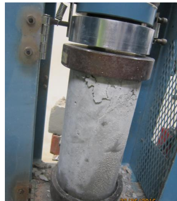
Figura N° 18: Se ve el tipo de falla que tuvo la probeta cuando fue ensayada a compresión.
