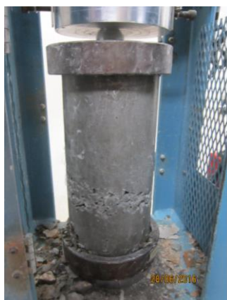
Figura N° 22: Se aprecian las micro fisuras en la parte inferior de la probeta.
