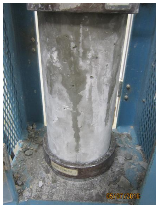
Figura N° 49: Se puede apreciar a la probeta de concreto en la máquina de compresión para ser ensayada.
