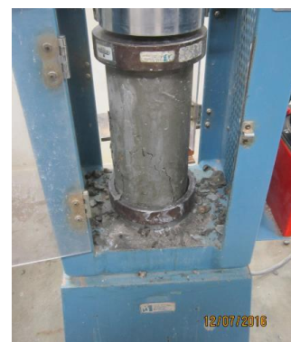
Figura N° 59: Se aprecian las fisuras en todas las partes de la probeta.
