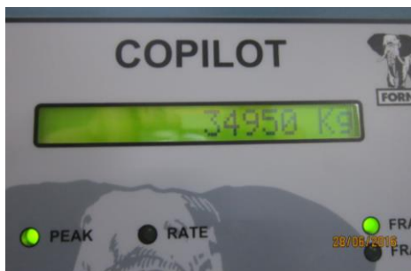
Figura N° 21: Se muestra la cantidad de carga que la probeta resistió, con este dato se determinó su resistencia a compresión.
