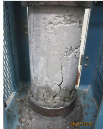
Figura N° 29: Se ve el tipo de falla que tuvo la probeta cuando fue ensayada a compresión.
