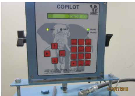
Figura N° 62: Se muestra la cantidad de carga que la probeta resistió, con este dato se determinó su resistencia a compresión.
