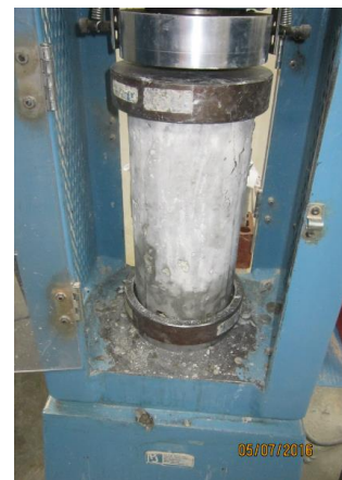
Figura N° 31: Se ve el tipo de falla que tuvo la probeta cuando fue ensayada a compresión.
