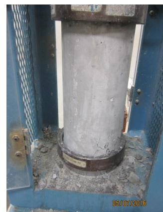
Figura N° 53: Se puede apreciar a la probeta de concreto en la máquina de compresión para ser ensayada.
