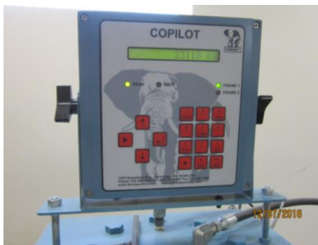
Figura N° 56: Se muestra la cantidad de carga que la probeta resistió, con este dato se determinó su resistencia a compresión.
