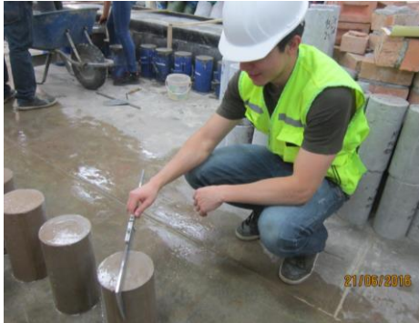
Figura N° 08: Se puede apreciar cómo se tomaron los parámetros de las probetas de concreto para luego ser ensayadas.
