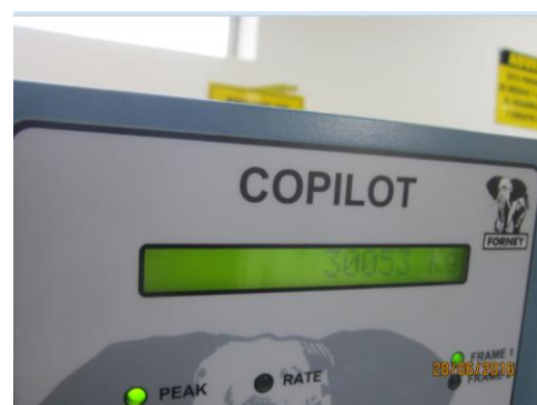
Figura N° 25: Se muestra la cantidad de carga que la probeta resistió, con este dato se determinó su resistencia a compresión.
