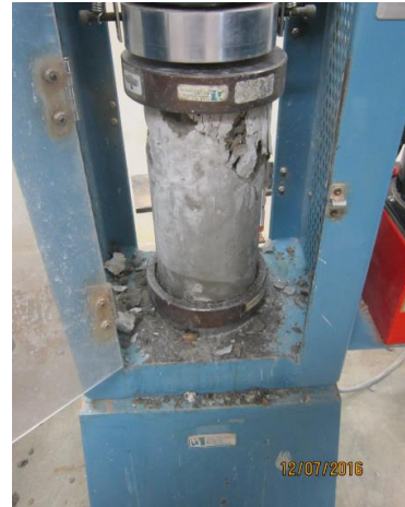
Figura N° 63: Se aprecian las fallas en todas las partes de la probeta.
