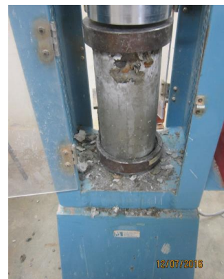
Figura N° 65: Se aprecian las fallas en todas las partes de la probeta.
