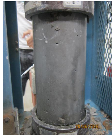
Figura N° 24: Se procede a ensayar la probeta de concreto a compresión.
