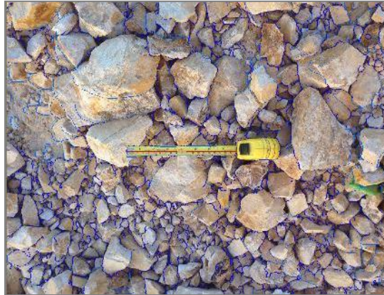
Figura 6.4 Medición de Fragmentación con Wipfrag - proyecto 440-V1.
