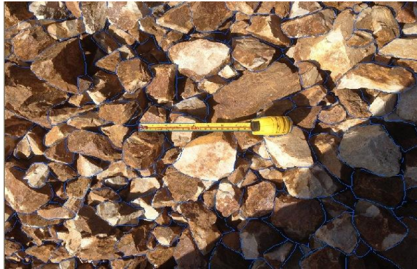
Figura 6.10 Medición Fragmentación con Wipfrag - proyecto 450-V2
