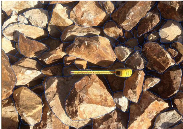
Figura 6.16 Medición de Fragmentación con Wipfrag - proyecto 460-V3
