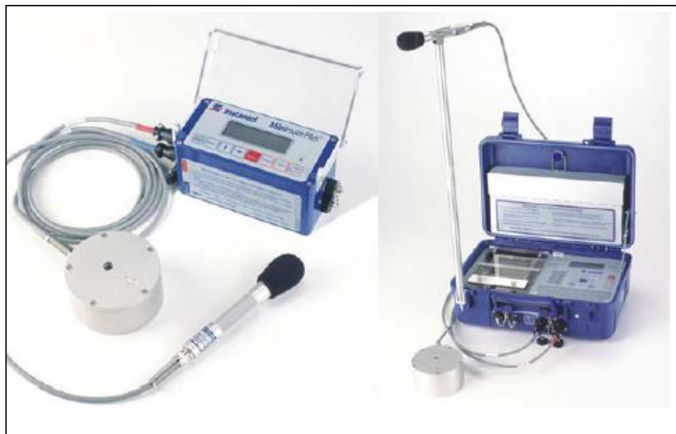
Figura 2.3 Sismógrafo con sus accesorios (Bernaola, Castilla 2013).
