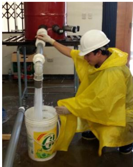
Fotografía N° 02: Medición del caudal de suministro (Qs).
