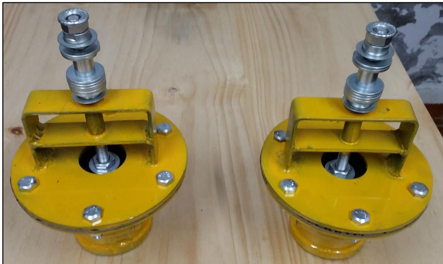
Fotografía N° 14: Válvulas de impulso ensamblada y terminada.
