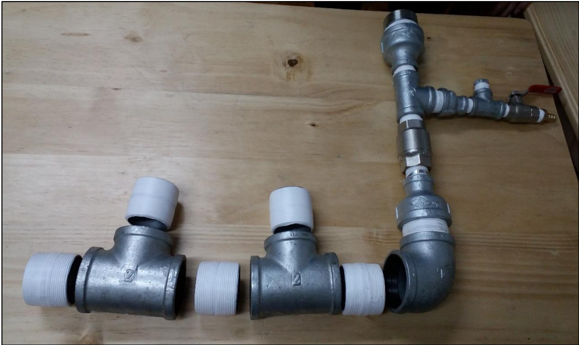
Fotografía N° 09: Despiece del cuerpo de la bomba de ariete.
