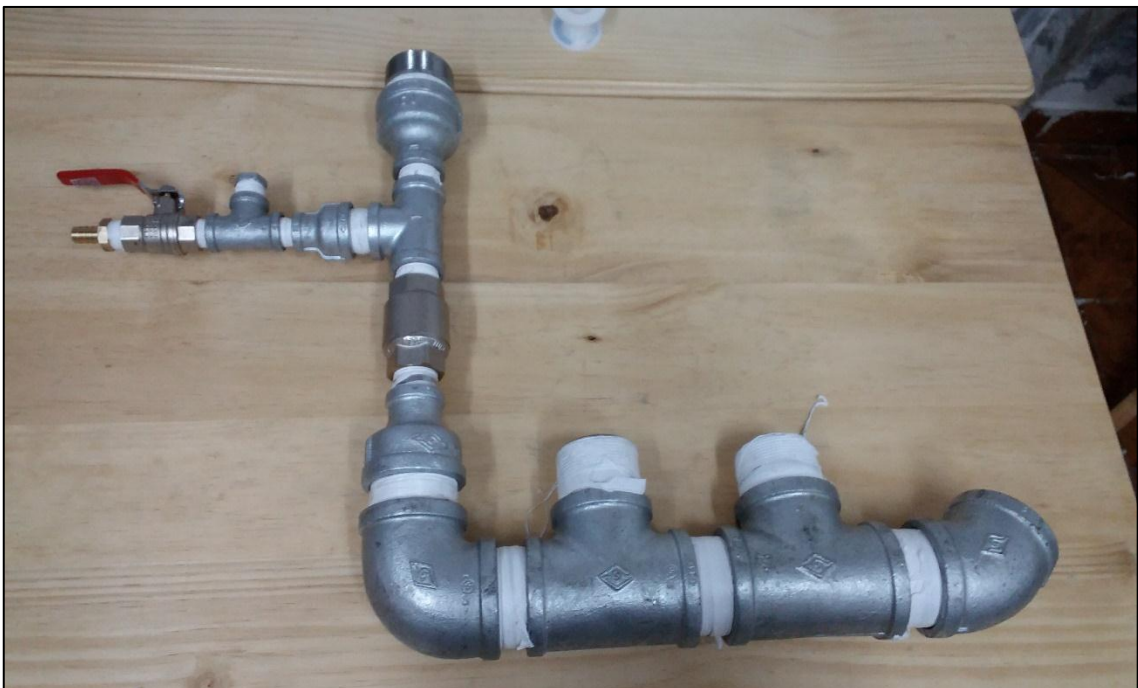
Fotografía N° 10: Cuerpo de la bomba de ariete ensamblado.
