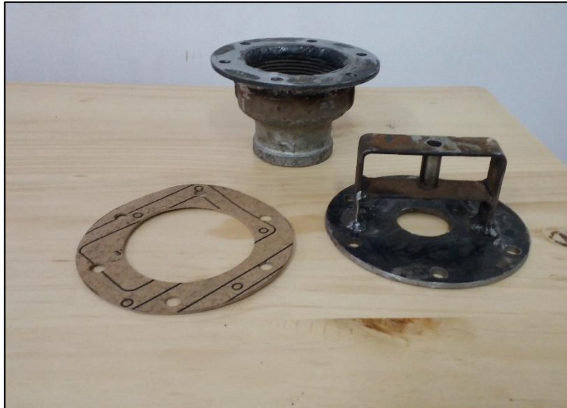
Fotografía N° 11: Elementos constituyentes de la válvula de impulsión.
