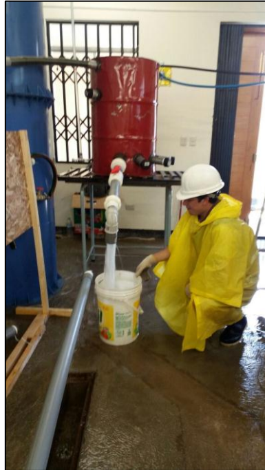
Fotografía N° 33: Tercer ensayo realizado en laboratorio de hidráulica de UPN-C; en el que se observa la medición del caudal de suministro (Qs).
