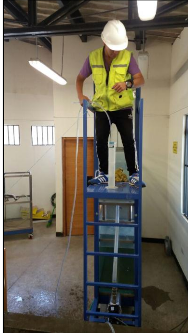
Fotografía N° 31: Tercer ensayo realizado en laboratorio de hidráulica de UPN-C; en el que se observa la medición del caudal de entrega ( Q_e ).
