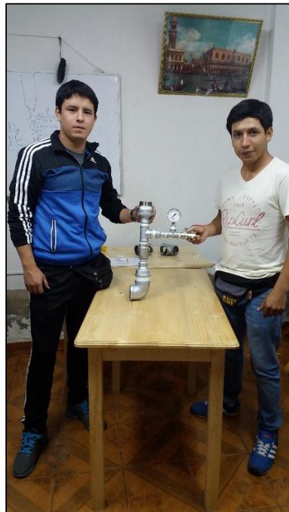
Fotografía N° 08: Ensamblaje de la bomba de ariete, zona de válvula de entrega concluida.
