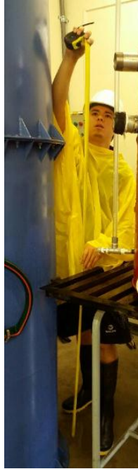
Fotografía N° 01: Medición de la altura de suministro (Hs).
