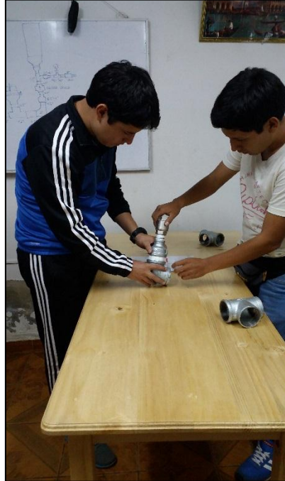
Fotografía N° 07: Ensamblaje de la bomba de ariete.
