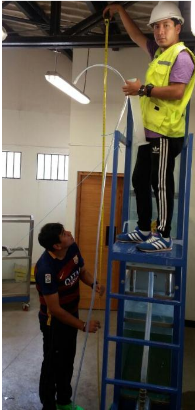
Fotografía N° 03: Medición de la altura de entrega ( H_e ).
