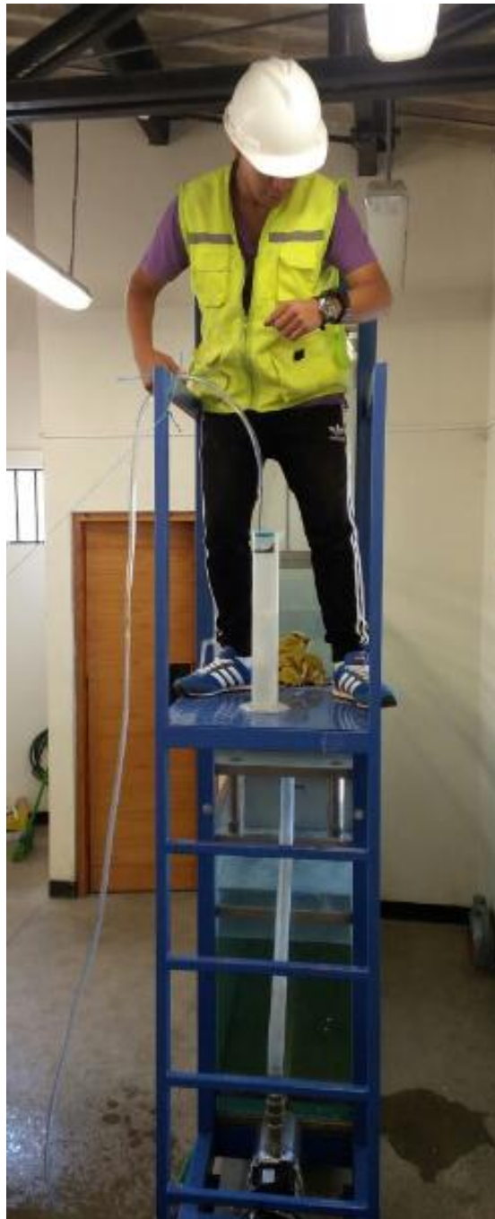
Fotografía N° 04: Medición del caudal de entrega ( Q_e ).
