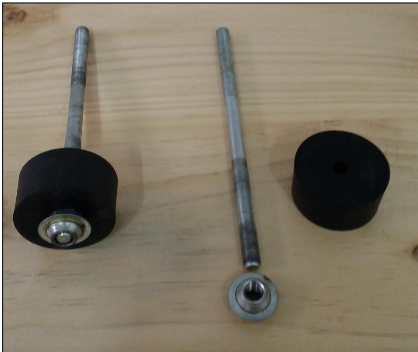
Fotografía N° 12: Ejes y émbolos de las válvulas de impulsión.
