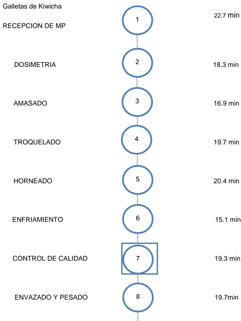
**Ilustración 21. Diagrama de operaciones del proceso (DOP), para la producción de 909.2 Kg de galleta**
