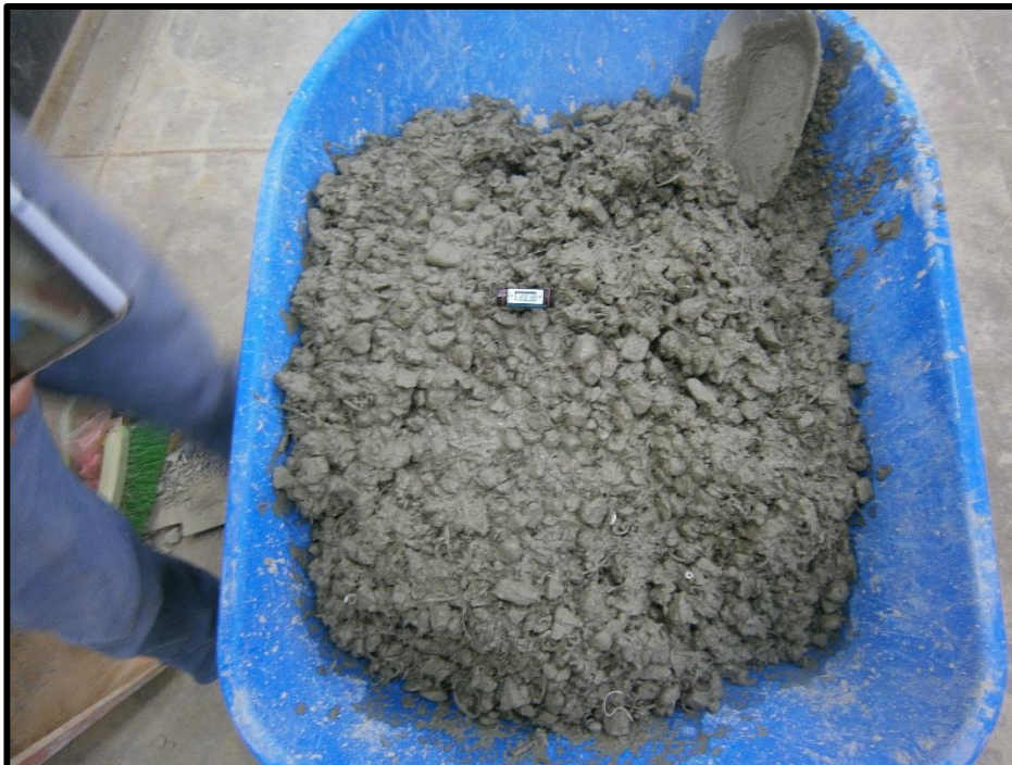
FOTOGRAFIA N° 32. Ensayo para medir la temperatura del concreto fresco.
