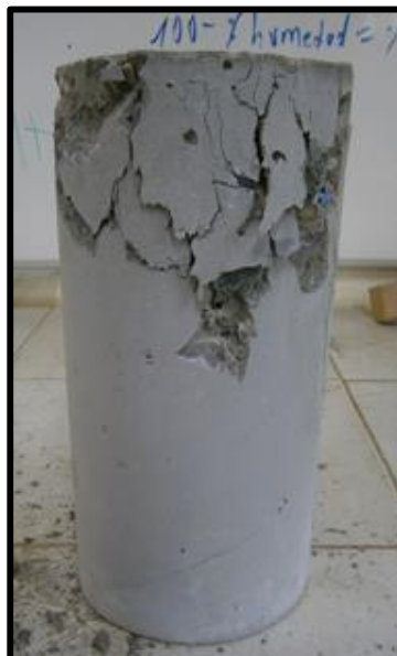
FOTOGRAFIA N° 8. Fractura presentada en la probeta 3 del diseño con 2% de viruta de acero a los 14 días (Fractura tipo II).
