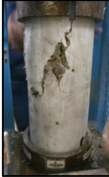
FOTOGRAFIA N° 13. Fractura presentada en la probeta 2 del diseño patrón a los 28 días (Fractura tipo IV).
