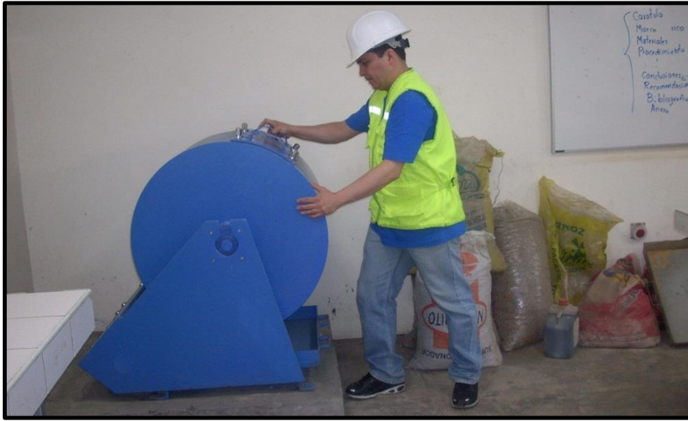
FOTOGRAFIA N° 27. Ensayo de abrasión del agregado grueso.
