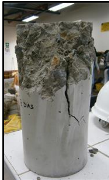
FOTOGRAFIA N° 14. Fractura presentada en la probeta 3 del diseño patrón a los 28 días (Fractura tipo II).
