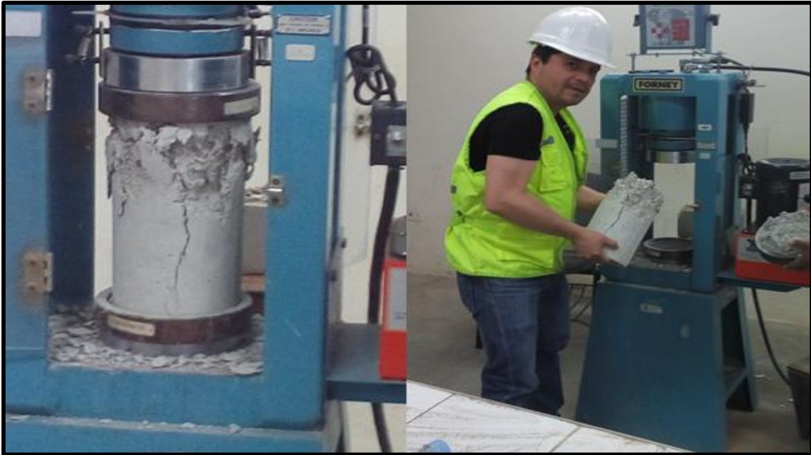
FOTOGRAFIA N° 38. Extracción de las probetas para analizar el tipo de falla.
