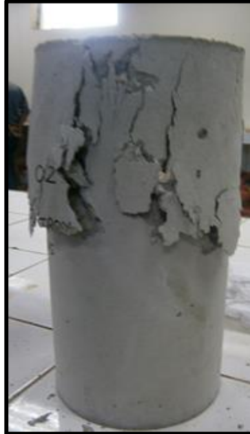
FOTOGRAFIA N° 7. Fractura presentada en la probeta 2 del diseño patrón a los 14 días (Fractura tipo II).
