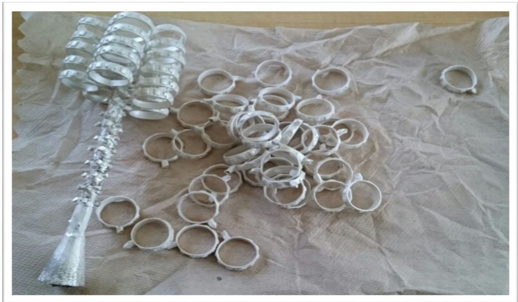
Figura n.º 66. Pieza de plata sin defecto modelo anillo.
