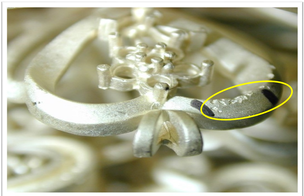
Figura n.º 58. Pieza de metal con porosidad.
