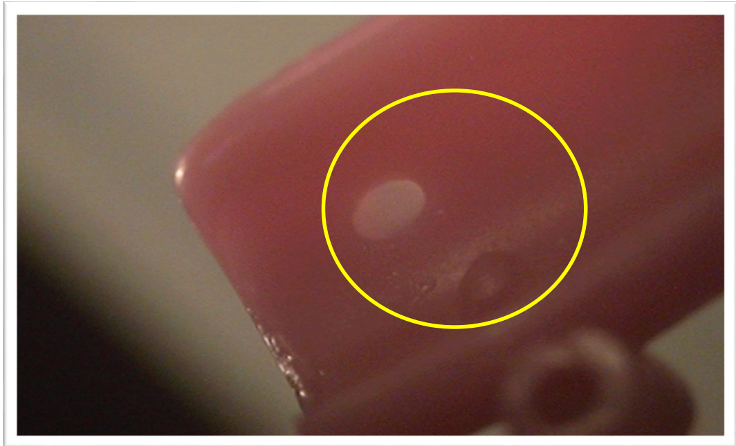
Figura n.º 53. Piezas de cera con burbuja de aire.
