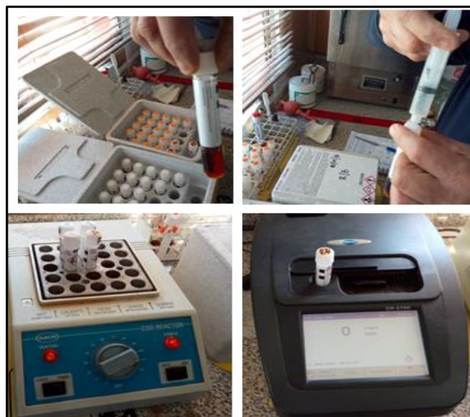
Figura n.º 3-16. Pasos a seguir para analizar el DQO.
