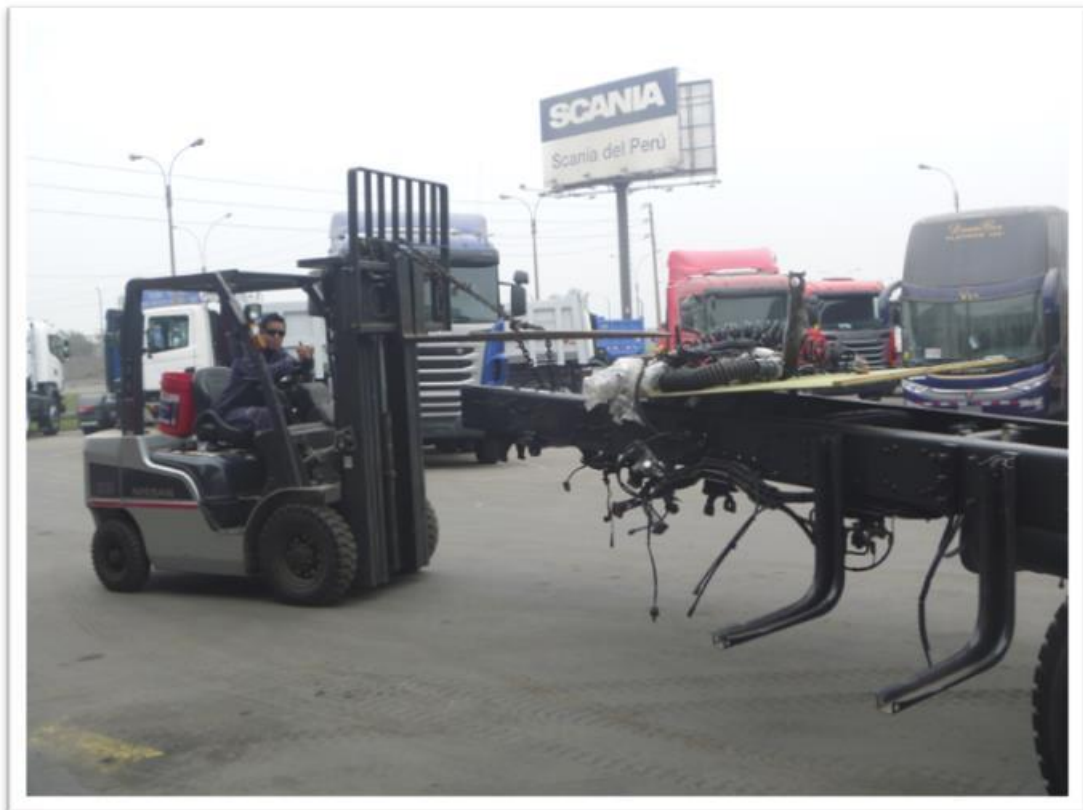
Figura n.º 3-10 Desarmado y traslado de componentes del Chasis.
