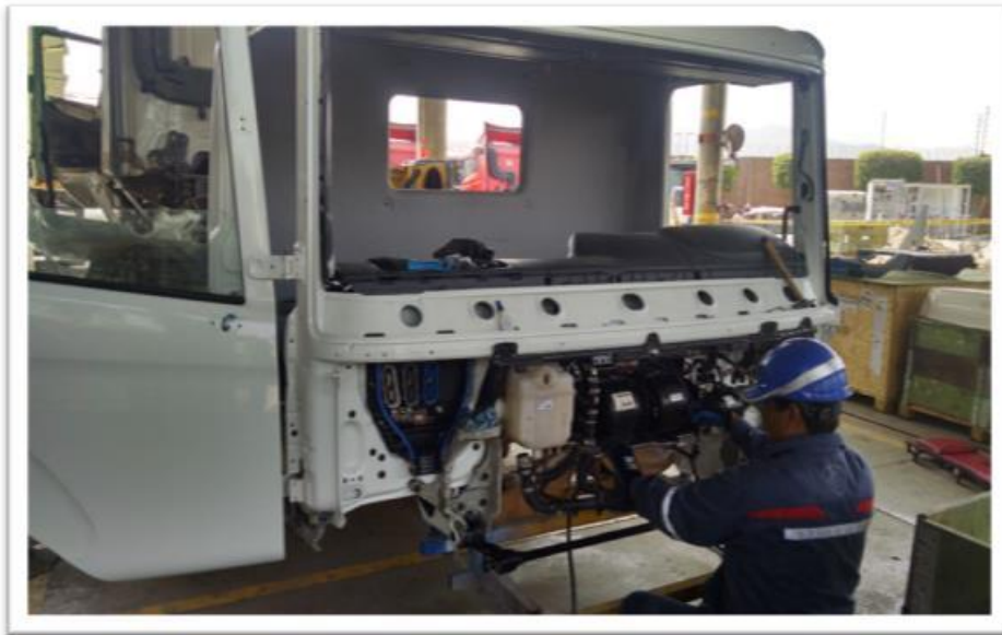
Figura n.º 3-12 Armado de cabina y componentes varios
