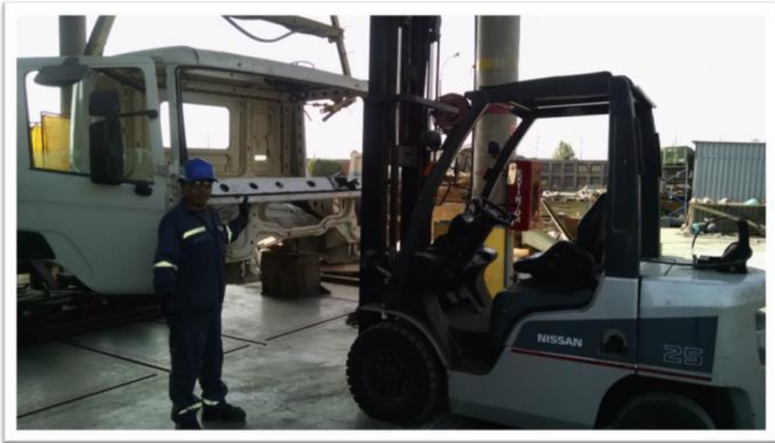
Figura n.º 3-8 Desmontaje y montaje de la cabina Scania
