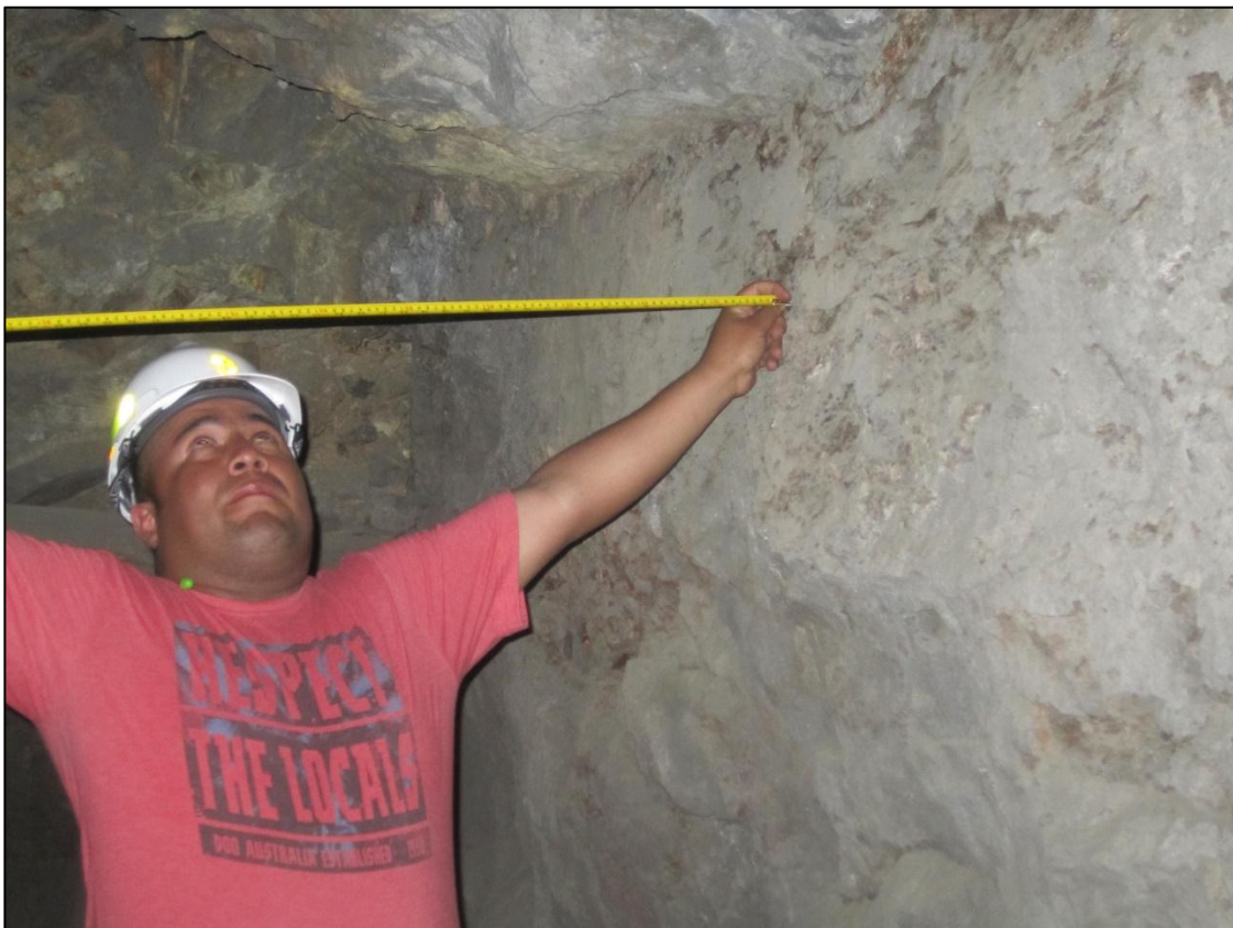
Figura 35: Medidas de datos geométricos del socavón.
