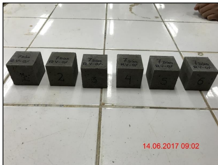
Fotografía N° 21: Probetas de mortero listas para el ensayo a compresión
