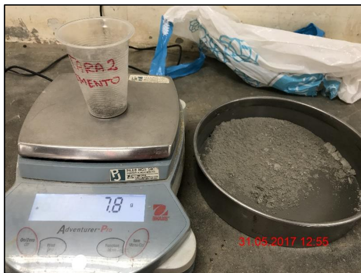
Fotografía N° 15: Peso del cemento retenido en el tamiz N° 200
