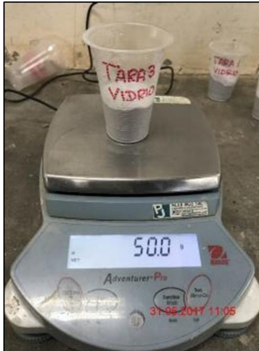
Fotografía N° 16: Peso del vidrio molido
