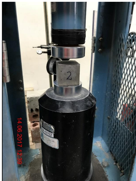
Fotografía N° 22: Ensayo a compresión de la probeta de mortero
