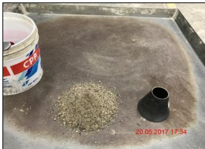
Fotografía N° 9: Agregado fino en estado saturado superficialmente seco
