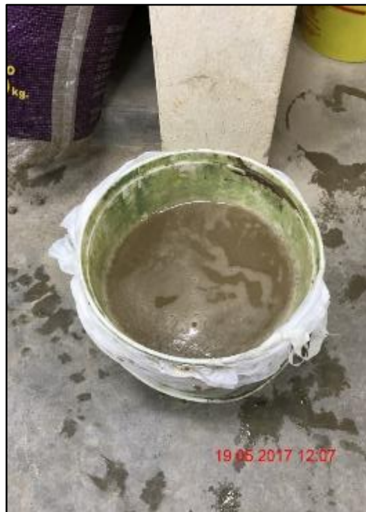
Fotografía N° 8: Agregado fino sumergido en agua por 24 horas
