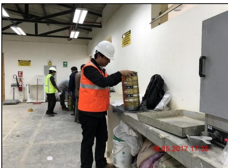
Fotografía N° 7: Tamizado del agregado fino
