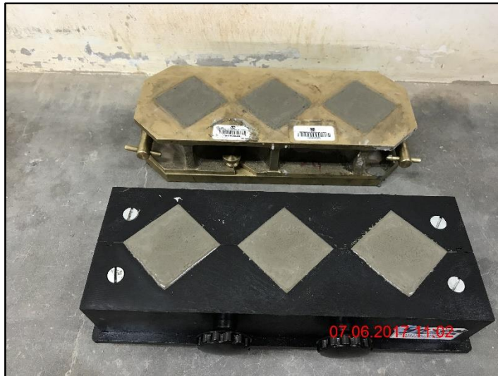
Fotografía N° 19: Especímenes de mortero
