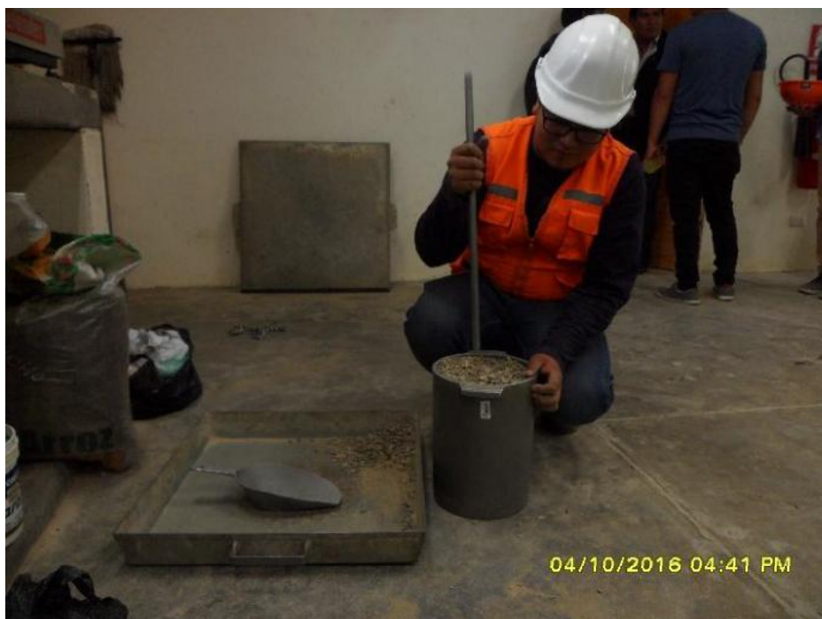
Figura n.º 162. Ensayo de peso unitario del agregado grueso.
