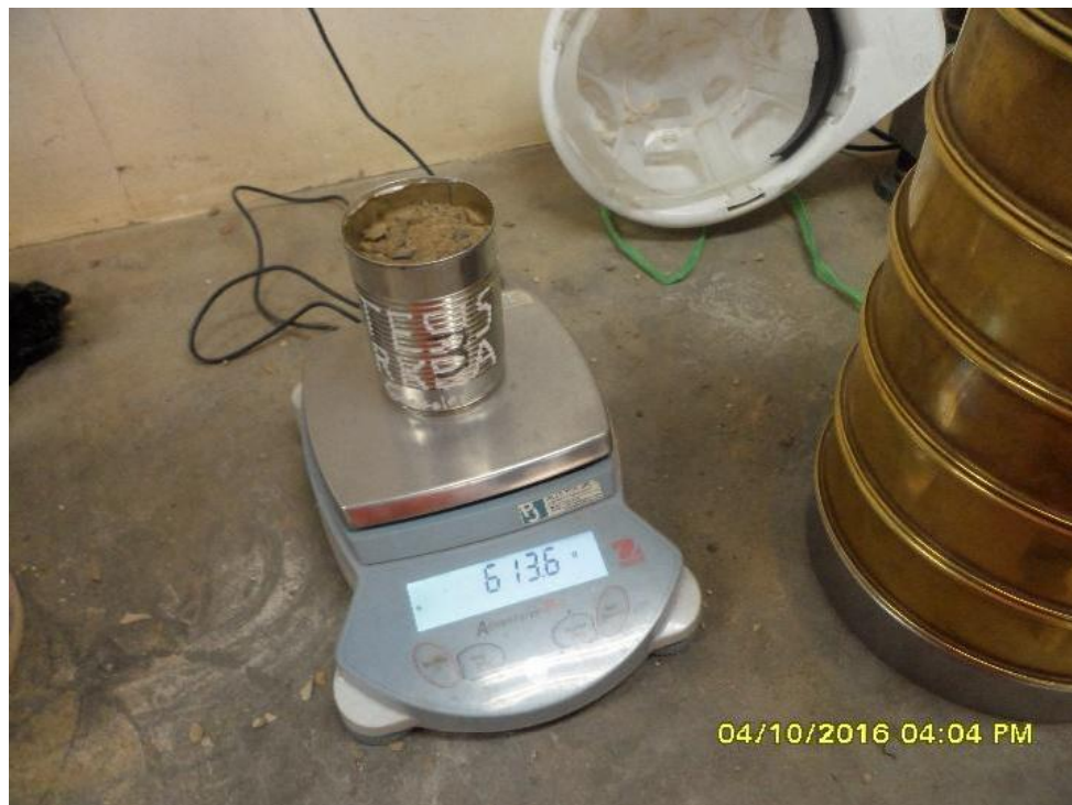
Figura n.º 160. Ensayo de contenido de humedad del agregado fino.
