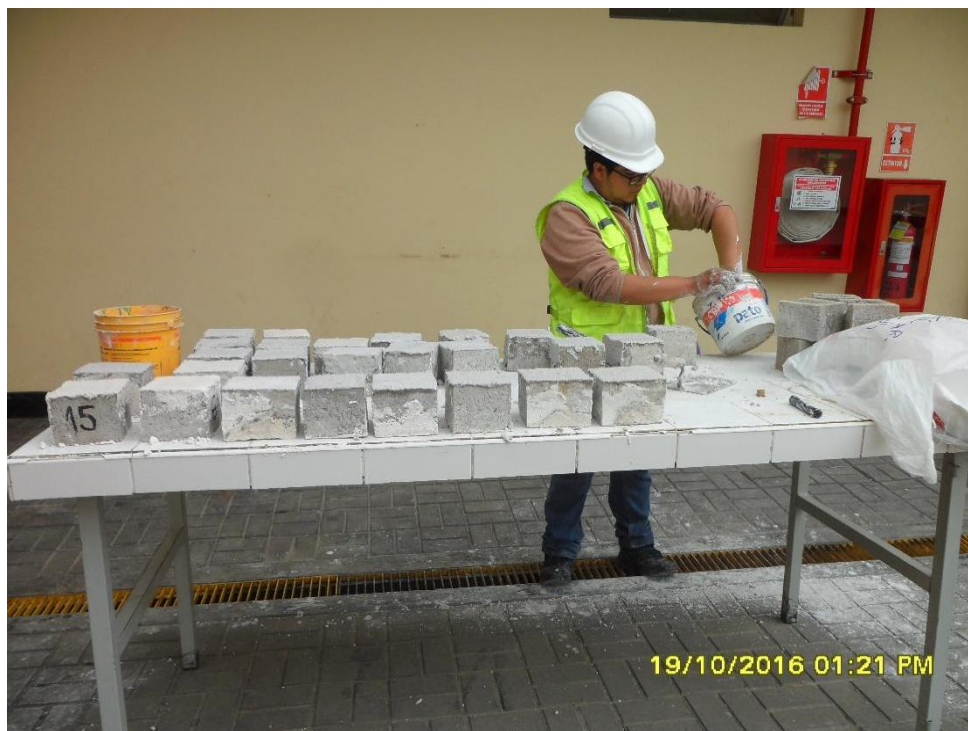
Figura n.º 180. Preparando muestras para ensayos de resistencia a compresión a los 7 días.
