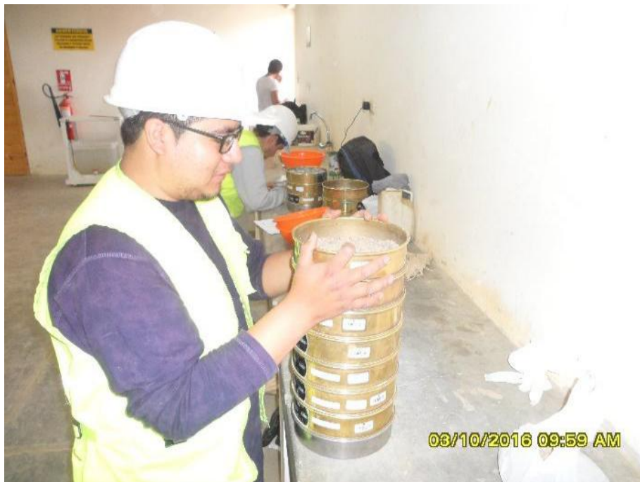
Figura n.º 158. Ensayo de granulometría del agregado fino.
