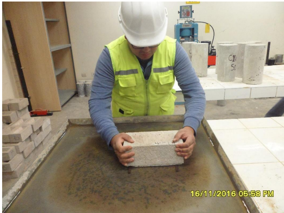
Figura n.º 191. Realizando ensayo de succión.
