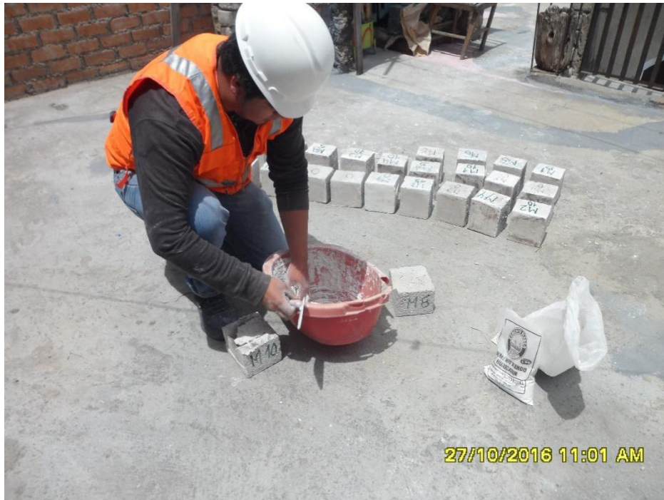
Figura n.º 183. Preparando muestras para ensayos de resistencia a compresión a los 14 días.
