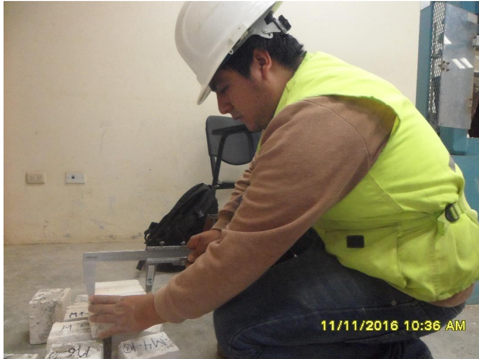
Figura n.º 185. Tomando medidas de muestras para ensayo de resistencia a compresión a los 28 días.
