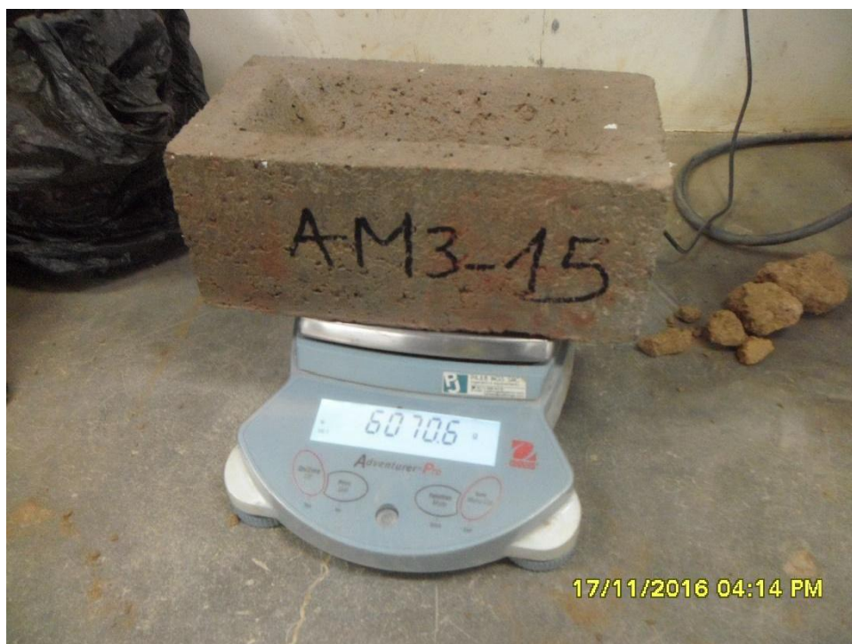
Figura n.º 194. Pesando ladrillos para el ensayo de absorción.
