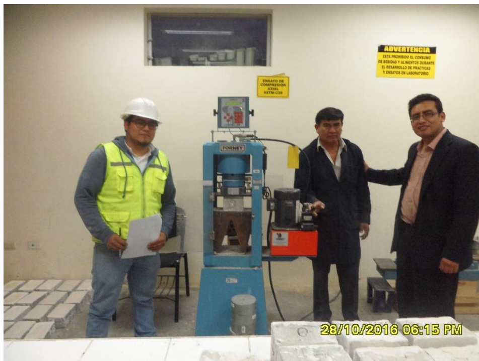
Figura n.º 184. Realizando ensayo de resistencia a compresión a los 14 días.
