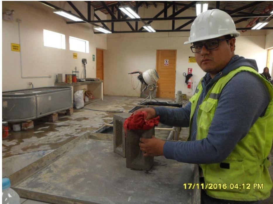
Figura n.º 193. Secando superficialmente los ladrillos para pesarlos para el ensayo de absorción.
