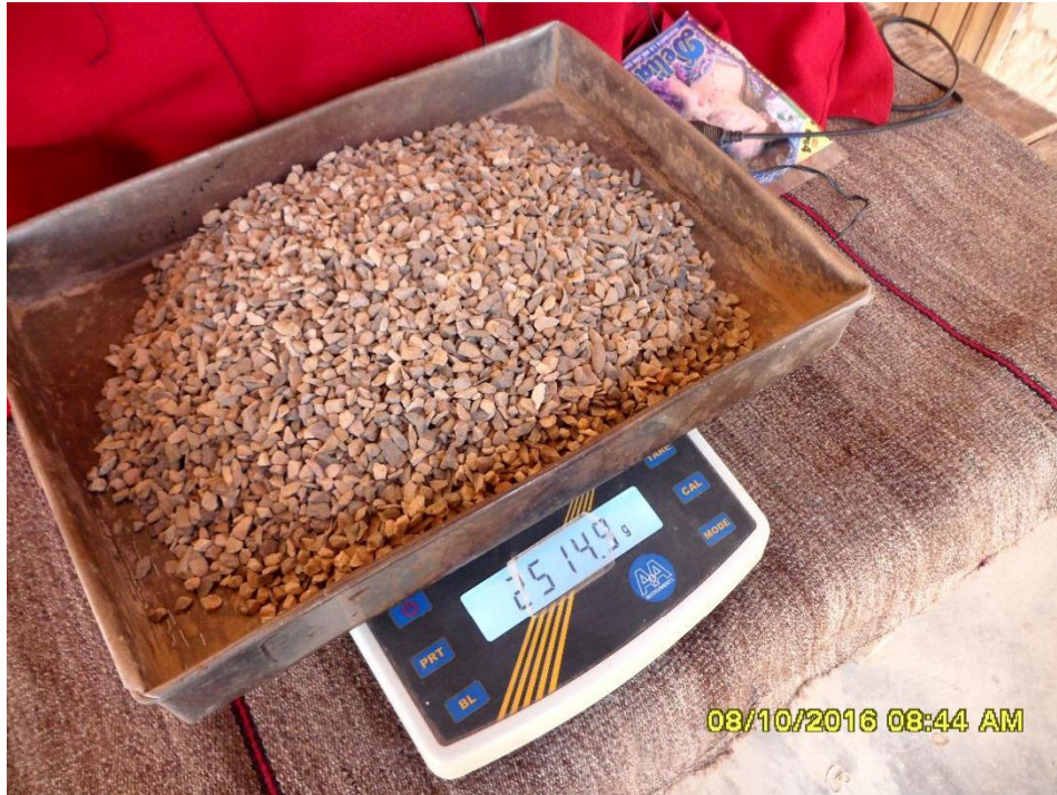
Figura n.º 171. Pesando material retenido en el tamiz n.º12, después del ensayo en la máquina de los ángeles.
