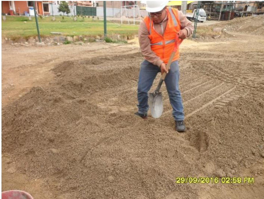
Figura n.º 155. Muestro de cantera, realización cuarteo de arena gruesa.
