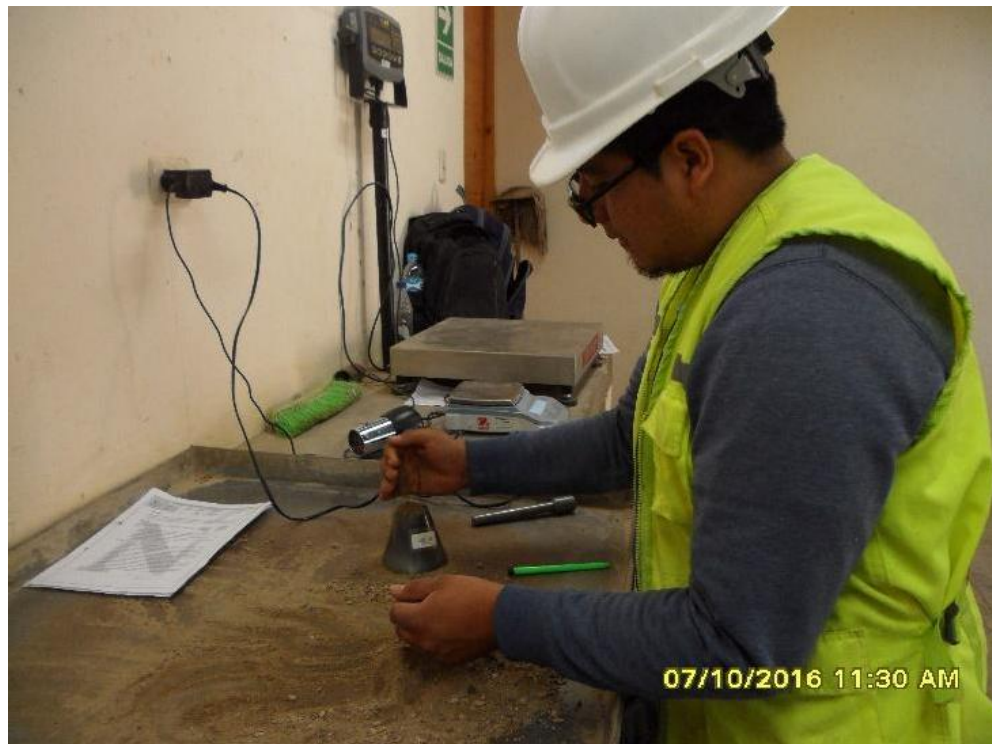
Figura n.º 166. Ensayo de peso específico del agregado fino.
