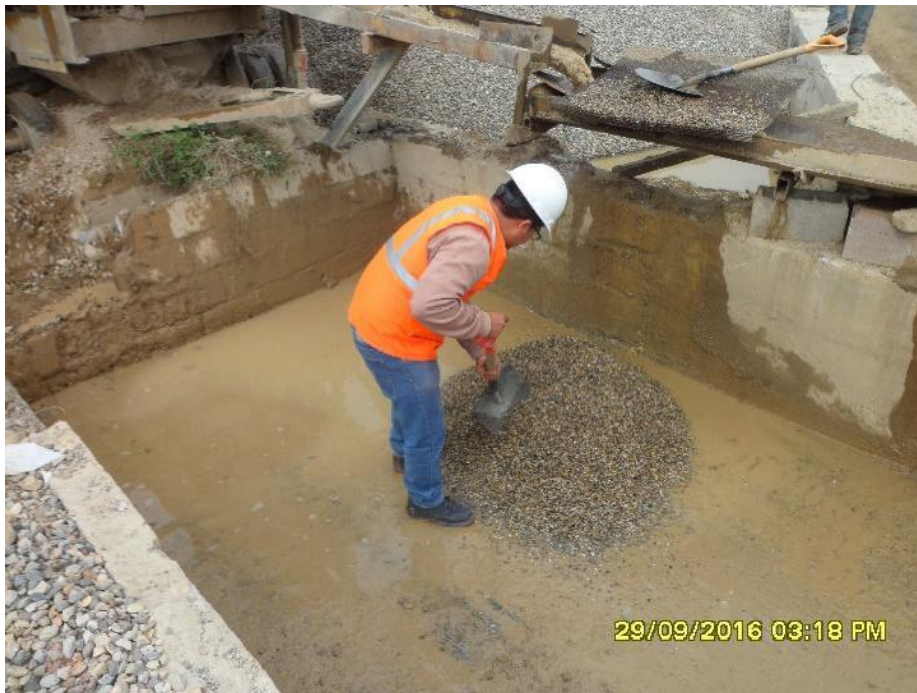
Figura n.º 156. Muestro de cantera, realización cuarteo de confitilio.
