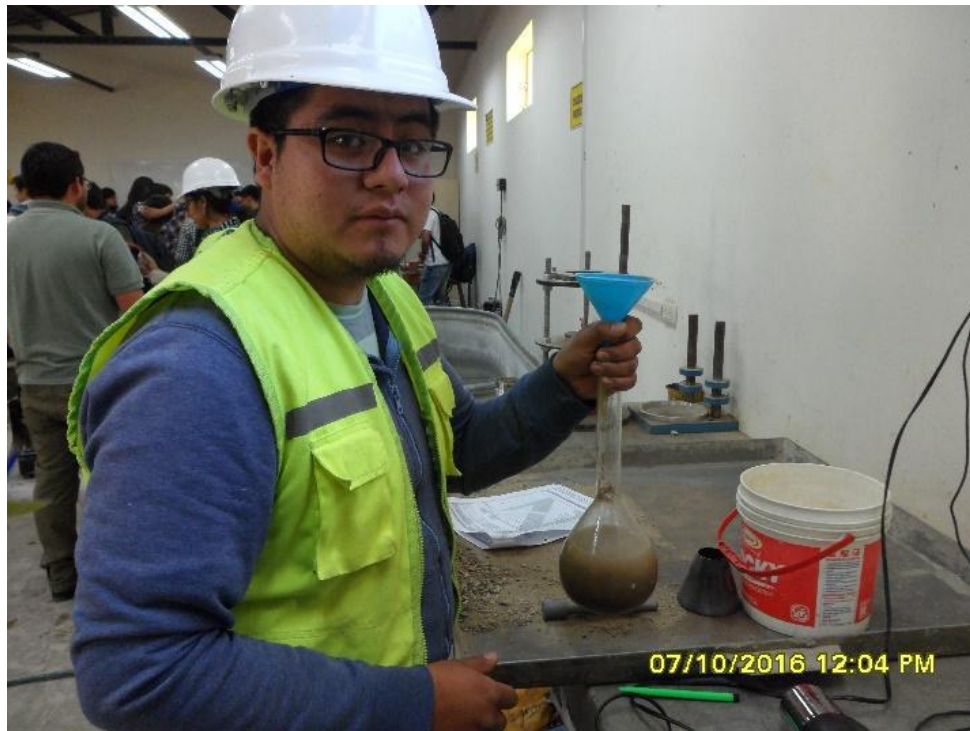
Figura n.º 167. Ensayo de peso específico del agregado fino.
