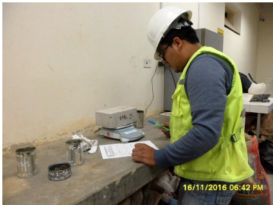
Figura n.º 192. Pesando ladrillos para ensayo de succión.
