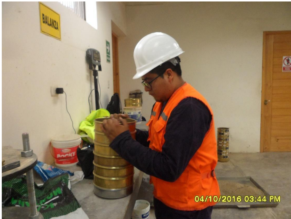
Figura n.º 159. Ensayo de granulometría del agregado grueso.
