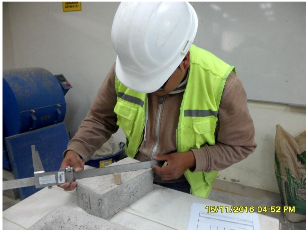
Figura n.º 189. Realizando ensayo de Alabeo.
