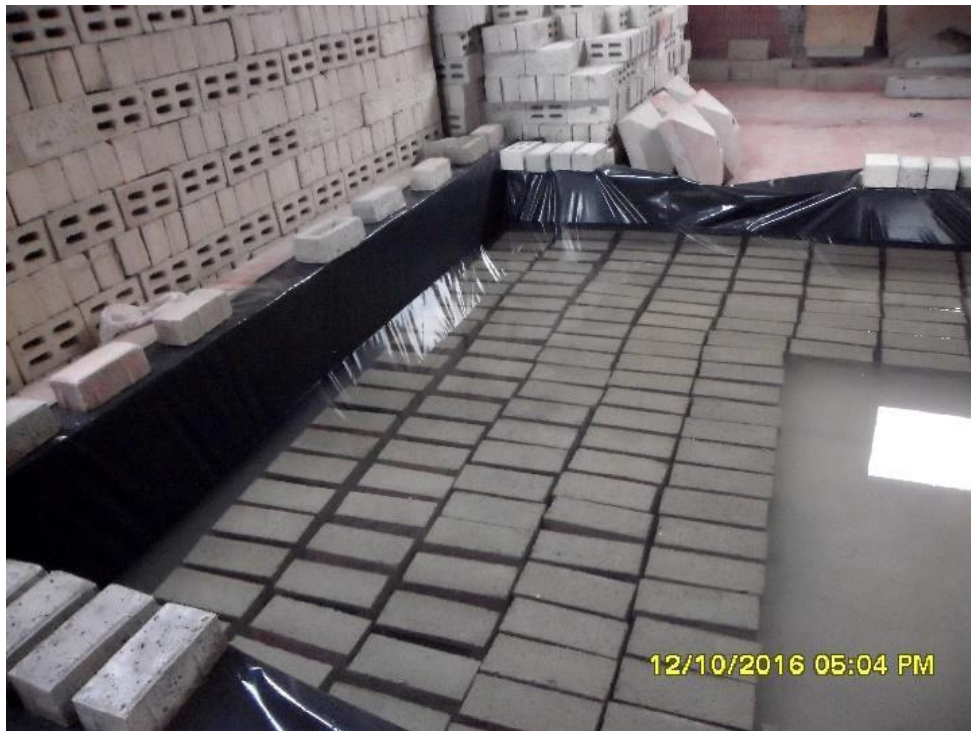
Figura n.º 179. Proceso de curado de los ladrillos.
