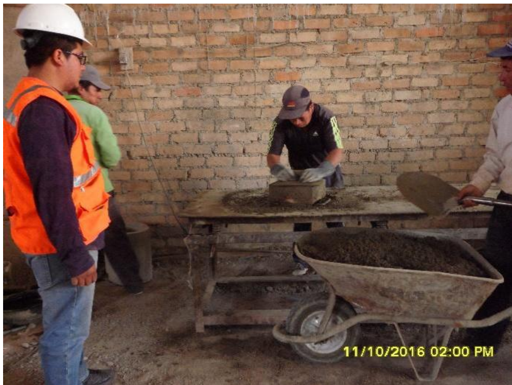
Figura n.º 176. Elaboración de ladrillos.
