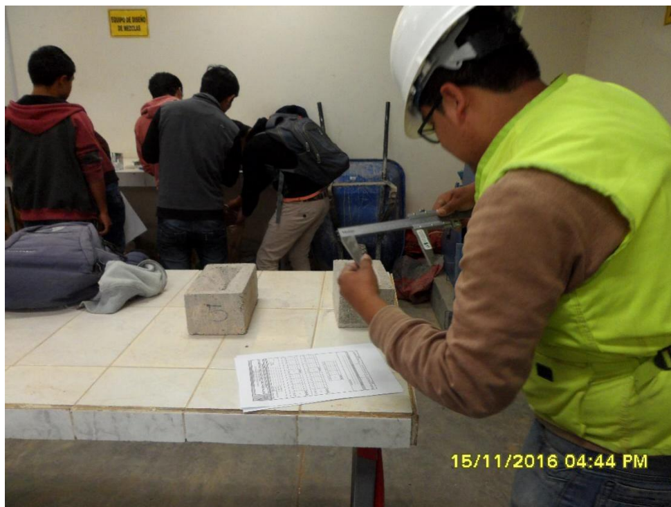
Figura n.º 188. Realizando ensayo de variación dimensional.
