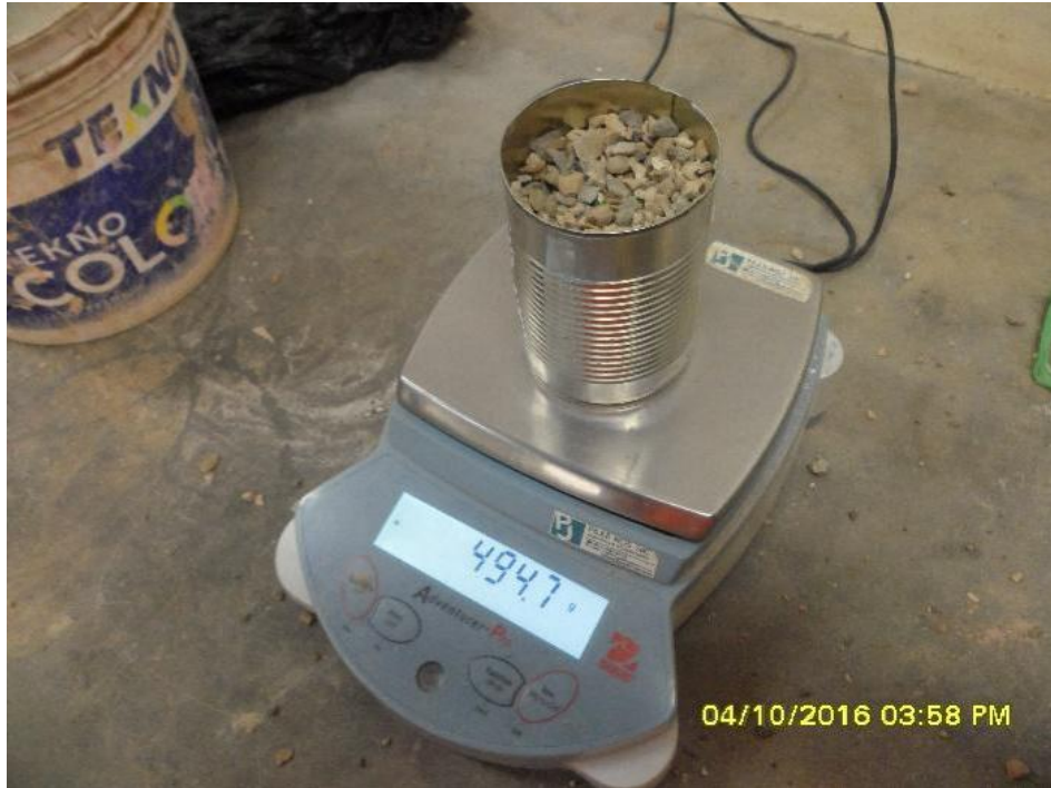
Figura n.º 161. Ensayo de contenido de humedad del agregado grueso.
