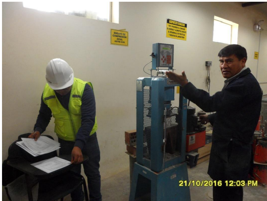
Figura n.º 182. Realizando ensayo de resistencia a compresión a los 7 días.
