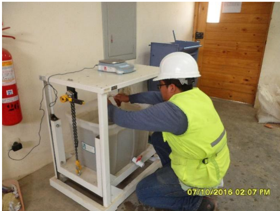
Figura n.º 168. Ensayo de peso específico del agregado grueso.
