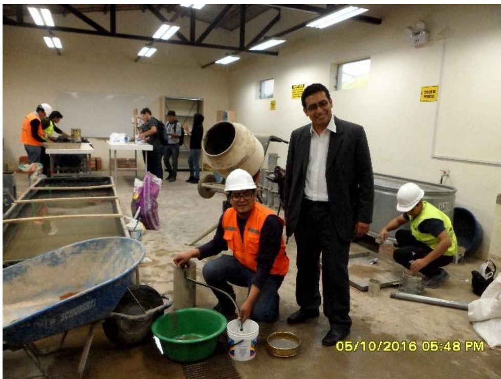
Figura n.º 164. Ensayo de material que pasa por el tamiz n.º 200.
