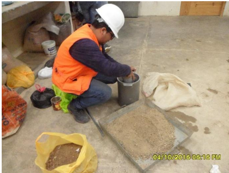
Figura n.º 163. Ensayo de peso unitario del agregado fino.
