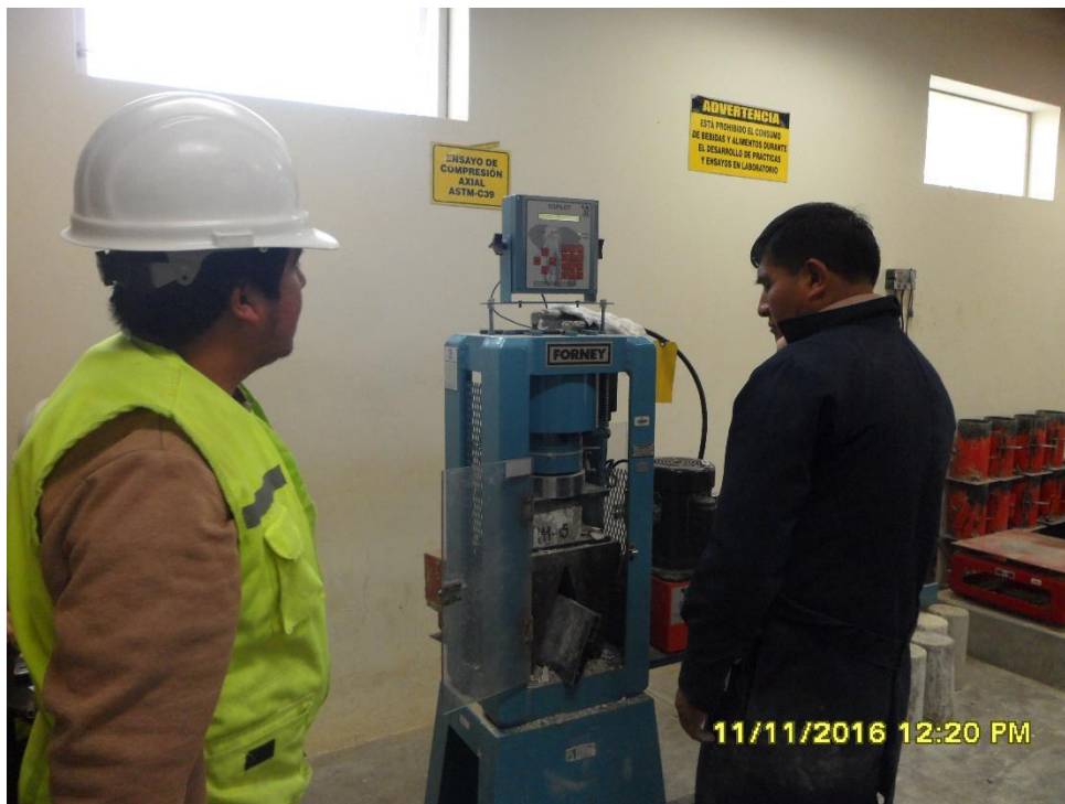
Figura n.º 186. Realizando ensayo de resistencia a compresión a los 28 días.
