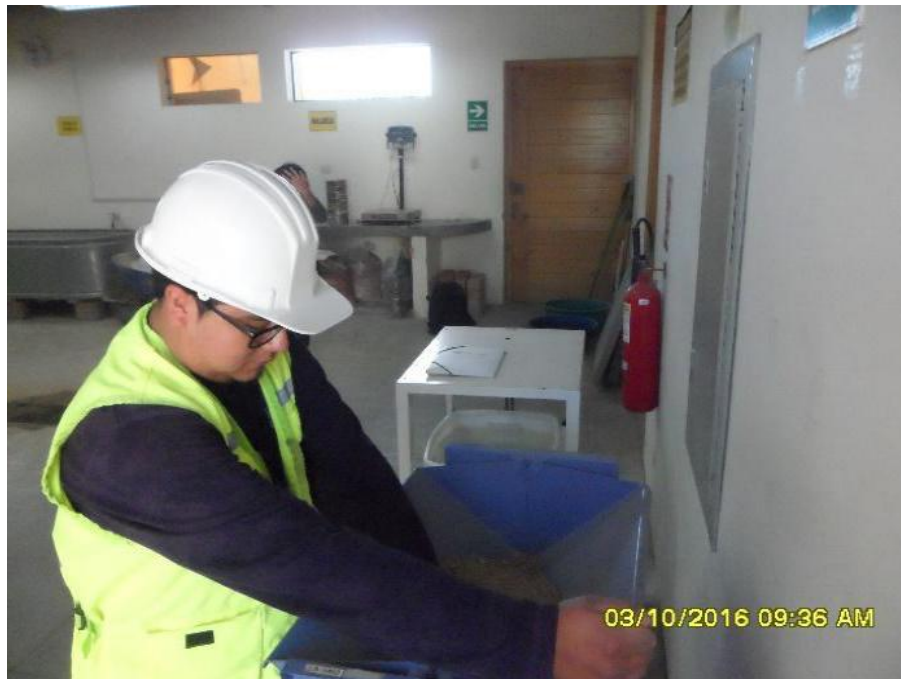
Figura n.º 157. Realizando cuarteo de agregados en laboratorio.
