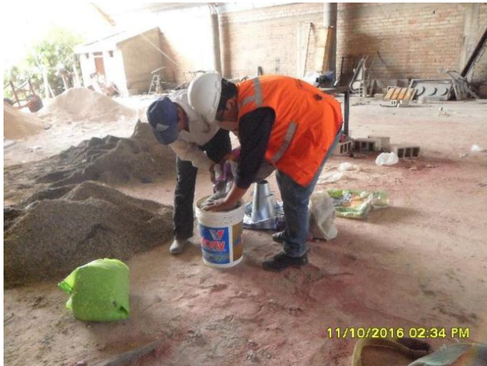
Figura n.º 177. Midiendo la cantidad de PET para la incorporación a la mezcla.
