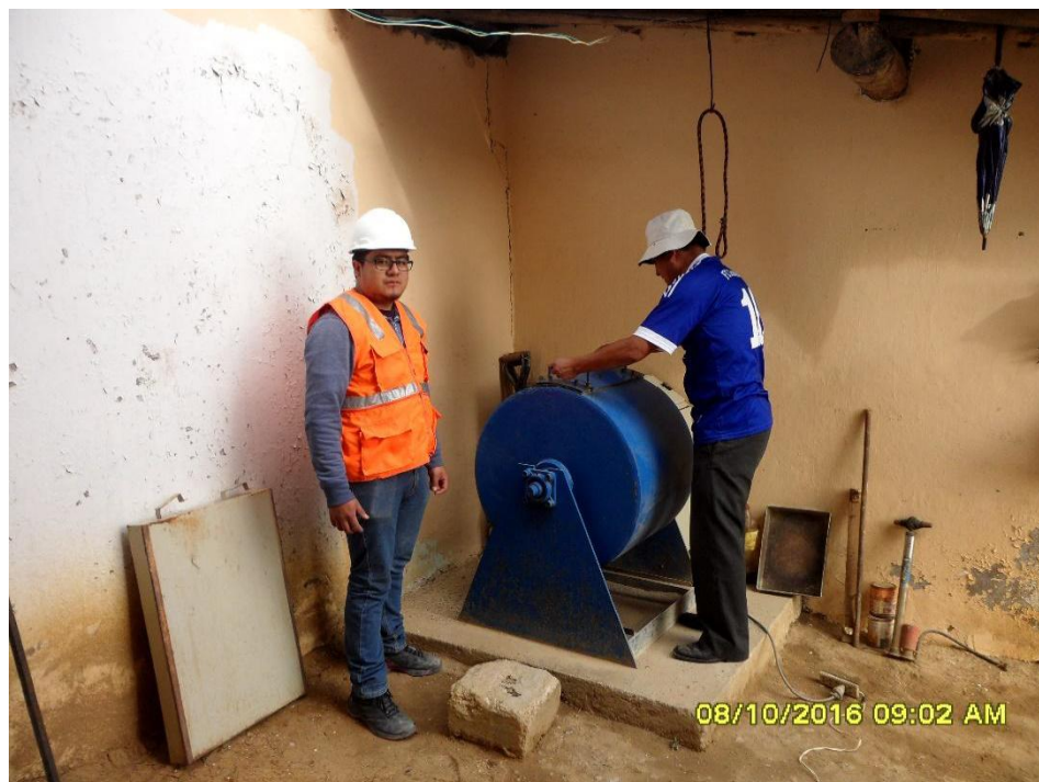
Figura n.º 170. Realizando ensayo de abrasión.
