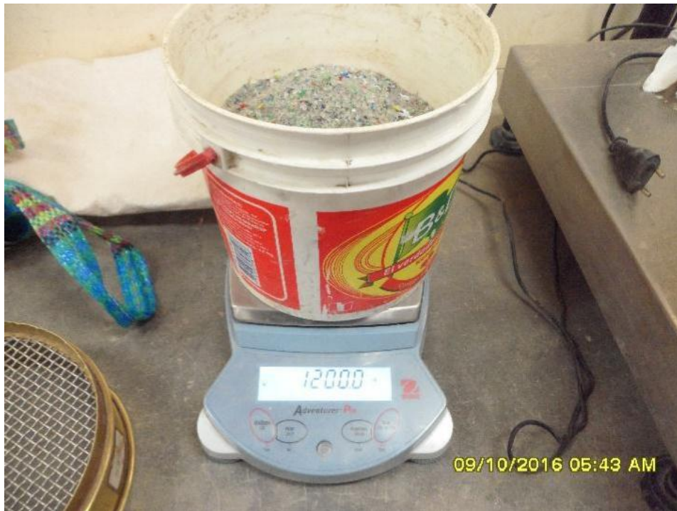
Figura n.º 169. Pesando PET molido para ensayo de granulometría.
