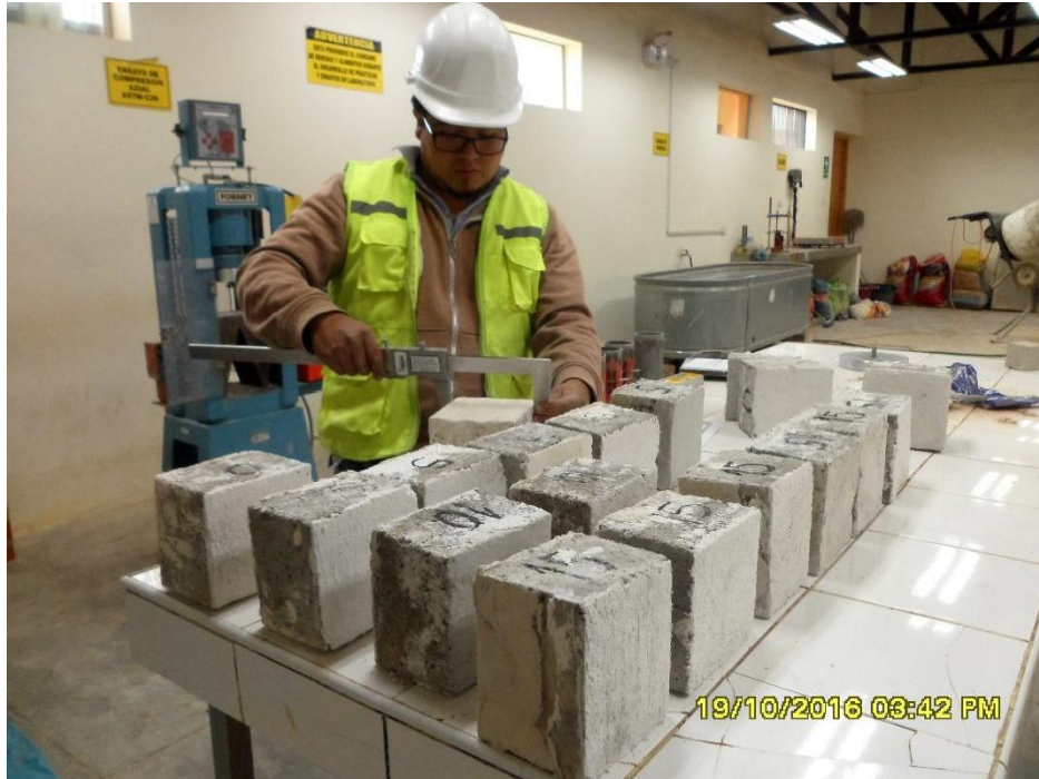
Figura n.º 181. Tomando medidas de muestras para ensayo de resistencia a compresión a los 7 días.
