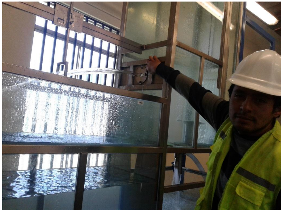
Figura n° 57. Verificamos el tipo de plancha con orificio que se está utilizando.
