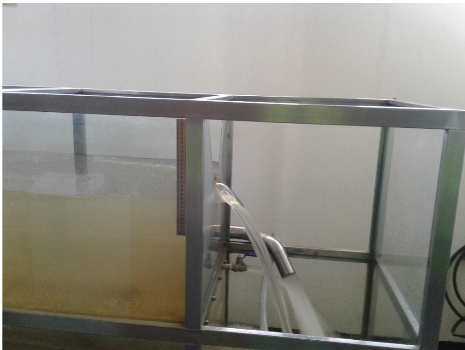
Figura n° 71. Anotamos la altura de agua en el vertedero para calcular el caudal.
