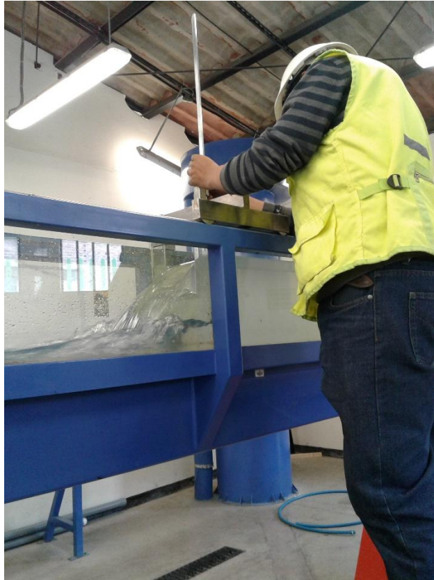
Figura n° 41. Fotografía de medición del tirante hidráulico en "a", para el ensayo de energía específica.
