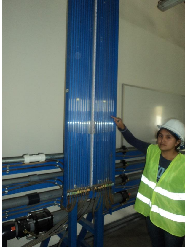
Figura n° 36. Tomamos nota de las alturas de agua generadas. El dato inicial de volumen.
