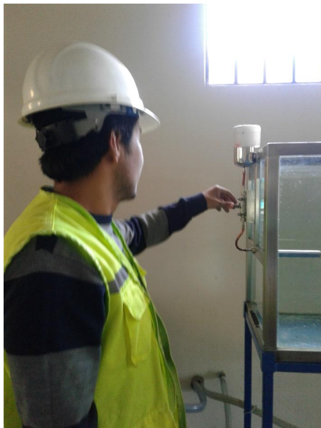
Figura n° 75. Abrimos la válvula de ingreso de colorante.
