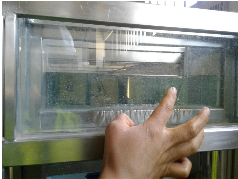
Figura n° 74. Llenamos la cuba hasta el vertedero de demasía, para obtener carga constante.
