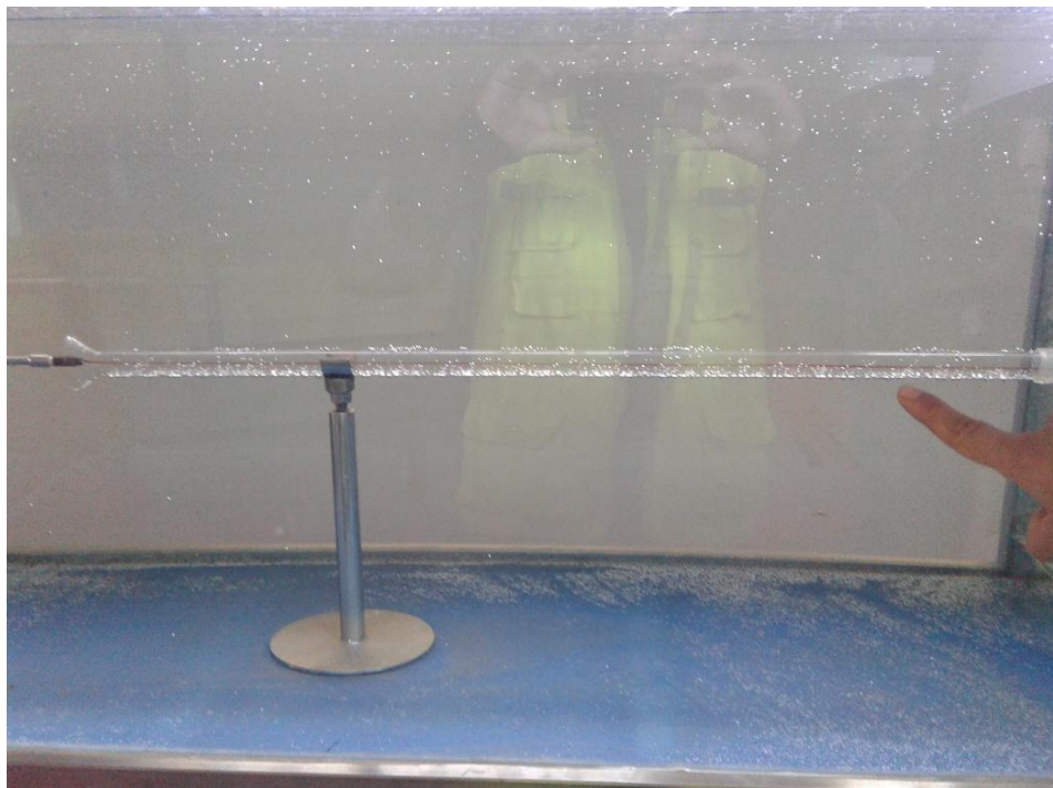
Figura n° 77. Cerramos la válvula de salida, hasta que alcanzamos un flujo laminar.
