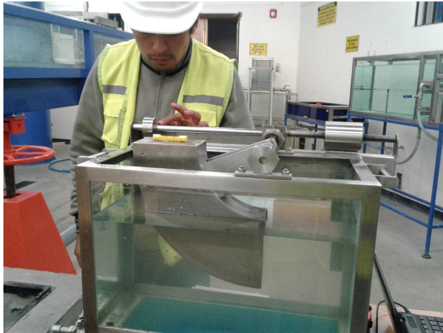
Figura n° 46. Aumentamos la carga hasta el vértice del cuadrante superior del equipo, nivelamos y obtenemos una medida “b”.
