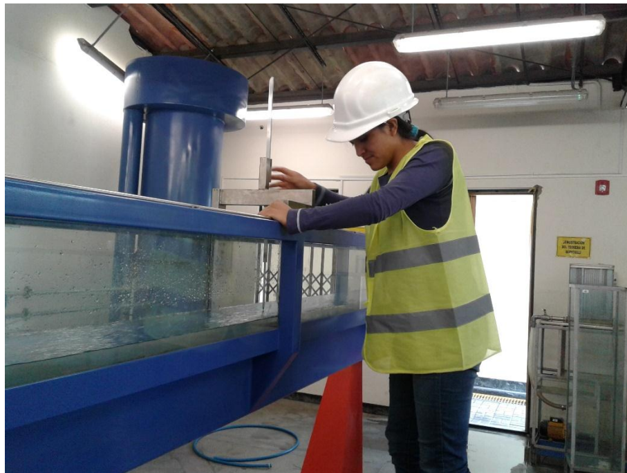
Figura n° 41. Fotografía de medición del tirante hidráulico en "a", para el ensayo de energía específica.
