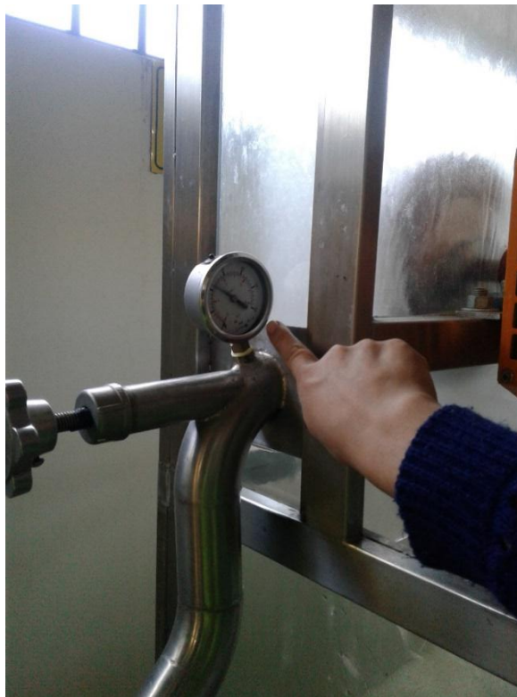
Figura n° 69. Abrimos la válvula que va hacia las cucharas de la turbina y anotamos la presión de salida.
