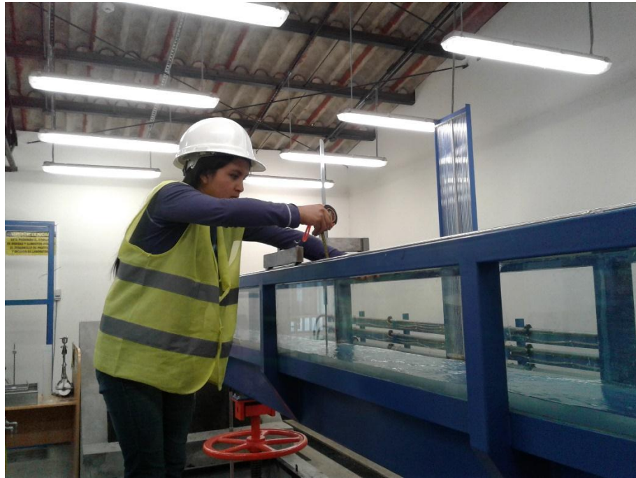
Figura n° 42. Fotografía de medición del tirante hidráulico en “b”, para el ensayo de energía específica.
