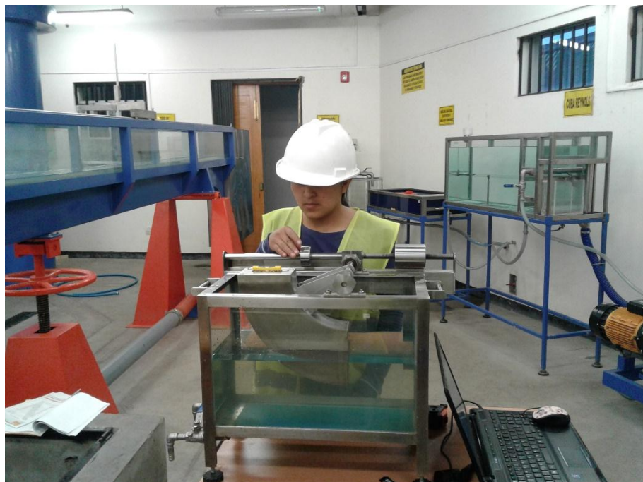
Figura n° 45. Aumentamos la carga y nivelamos con la pesa, obteniendo una medida “a”.
