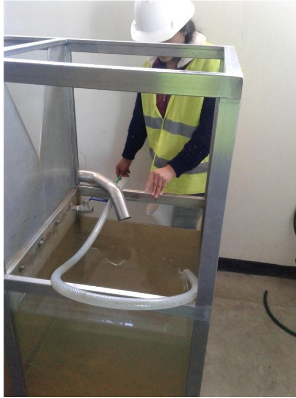
Figura n° 69. Abrimos la válvula que va hacia las cucharas de la turbina y anotamos la presión de salida.
