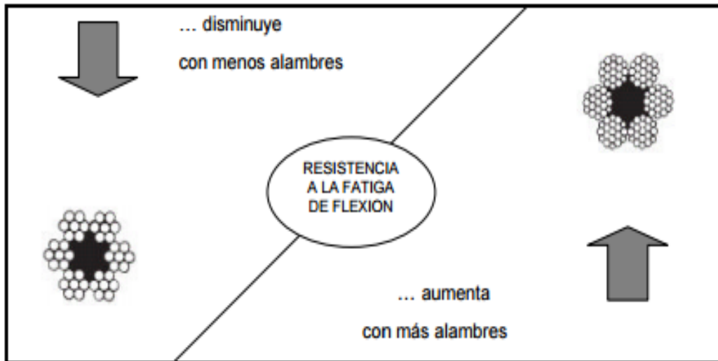
Figura n.º 2.7 Influencia de cantidad de alambres en la resistencia a la fatiga de flexión.
