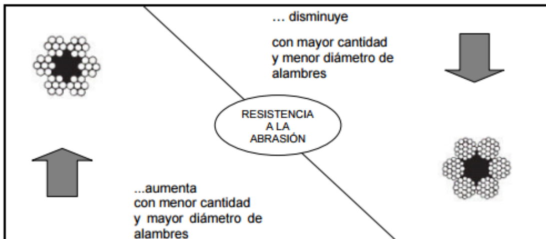
Figura n.º 2.8 Influencia de cantidad y diámetro de los alambres en la resistencia a la abrasión.
