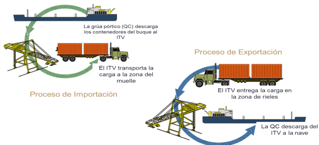
Figura n.º 3.4 Proceso interno en el servicio que ofrece Dp World Callao cuando llega o se retira un buque del terminal
