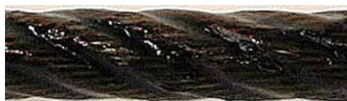
Figura n.º 3.25 Cable lubricado con recubrimiento de grasa
