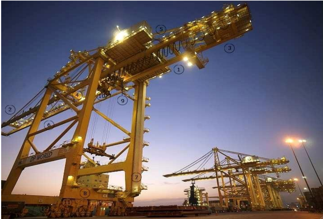
Figura n.º 1.3 Partes principales de la grúa pórtico QC.
