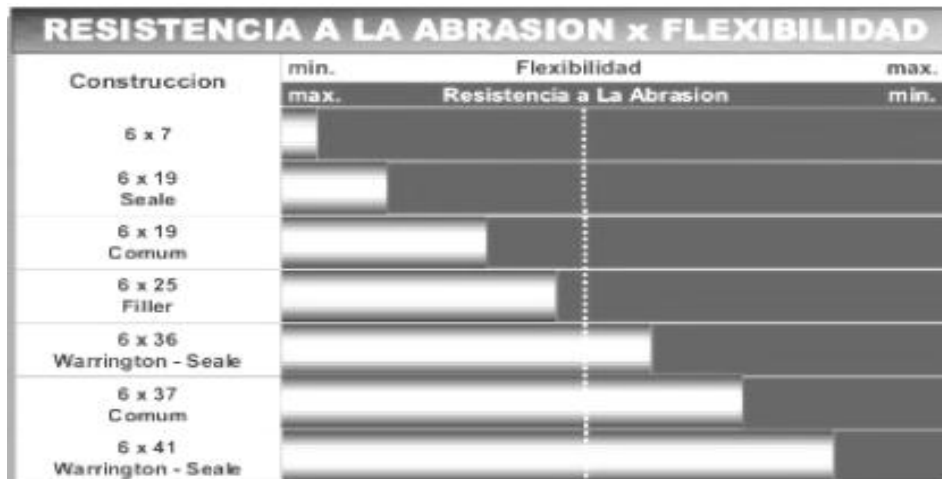
Figura n.º 2.11 Relación entre la resistencia a la abrasión y la resistencia a la fatiga.
