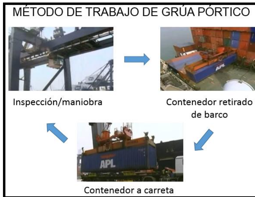
Figura n.º 3.16 Método de trabajo de la grúa pórtico
