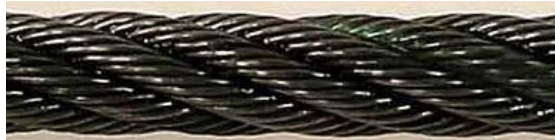
Figura n.º 3.24 Cable lubricado con espuma penetrante
