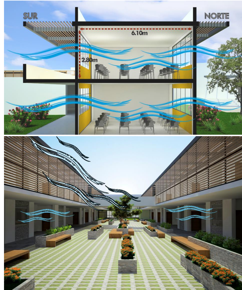
Figura N° 22: Ventilación Cruzada y Por Patios.
