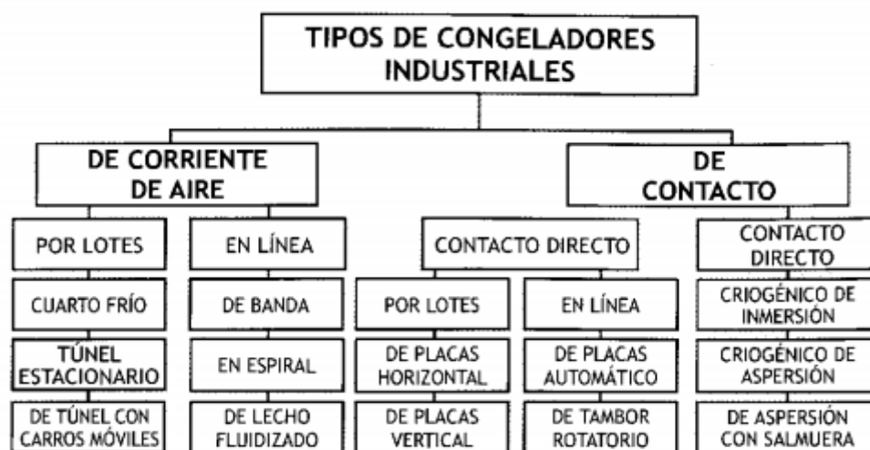
Figura n.º 1: Tipo de congeladores industriales
