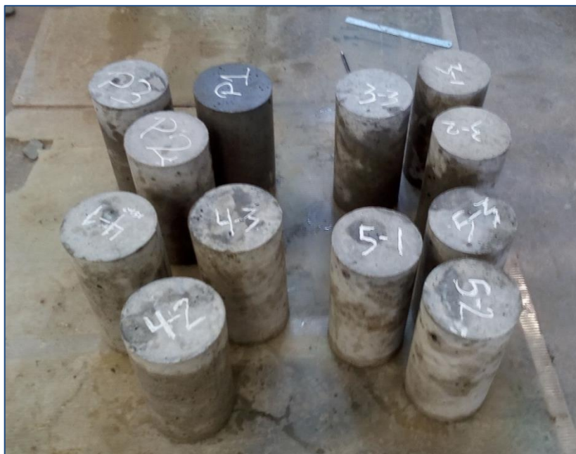
Figura 37: Probetas cilíndricas después de los 28 días de curado (ASTM C-31)
