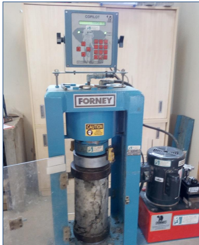
Figura 38: Ensayo de Resistencia a la Compresión (ASTM C-39)
