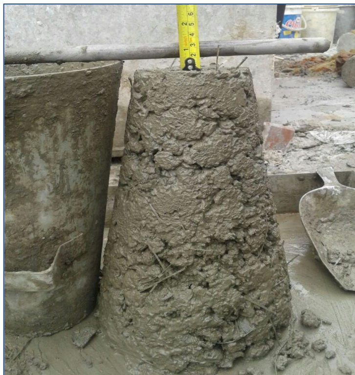
Figura 31: Ensayo de Asentamiento en el Concreto, con 3 kg/m 3 de fibra (ASTM C-143)
