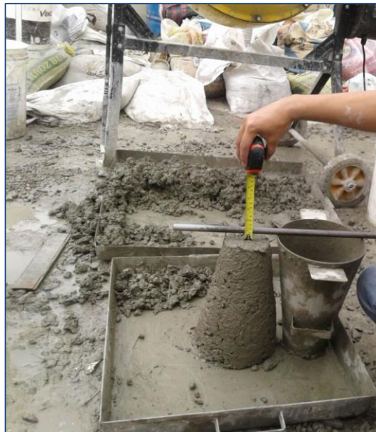
Figura 33: Ensayo de Asentamiento en el Concreto, con 5 kg/m 3 de fibra (ASTM C-143)
