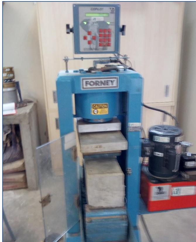
Figura 40: Ensayo de Resistencia a la Flexión (ASTM C-78)
