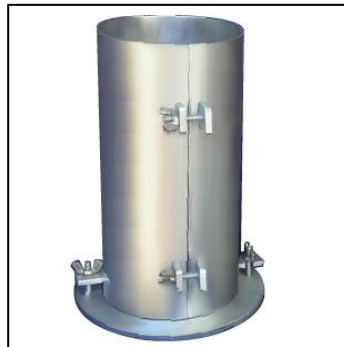
Figura 07: Molde para el ensayo de resistencia compresión.
