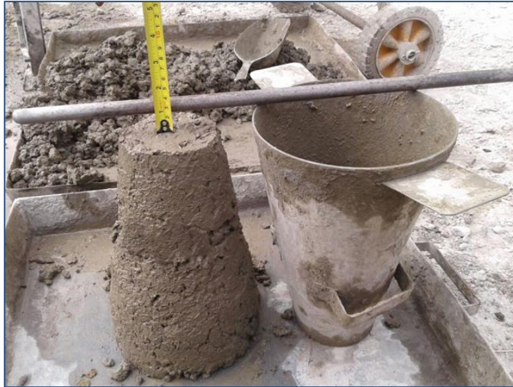
Figura 30: Ensayo de Asentamiento en el Concreto, con 0 kg/m 3 de fibra (ASTM C-143)
