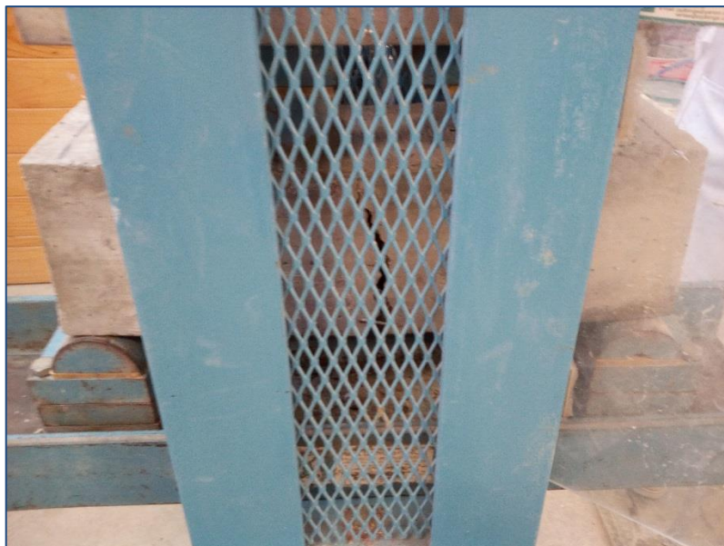
Figura 41: Viga ensayada a flexión reforzada al 5 kg/m 3 (ASTM C-78)
