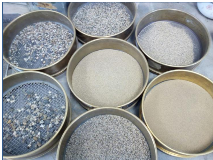
Figura 23: Ensayo de Análisis granulométrico (ASTM C-136)
