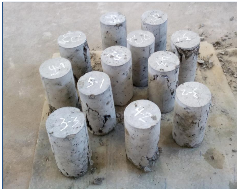
Figura 39: Especímenes ya ensayados a compresión (ASTM C-39)
