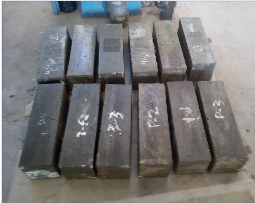
Figura 36: Vigas después de los 28 días de curado (ASTM C-31)
