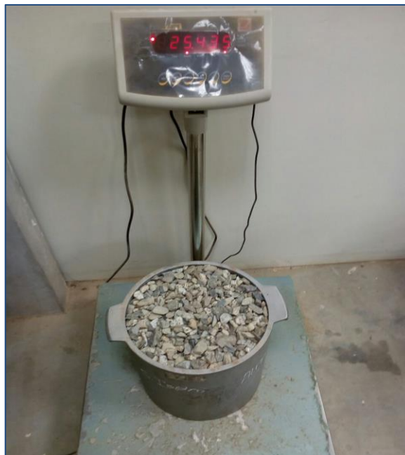
Figura 25: Ensayo de PUSS y PUSC (ASTM C-136)
