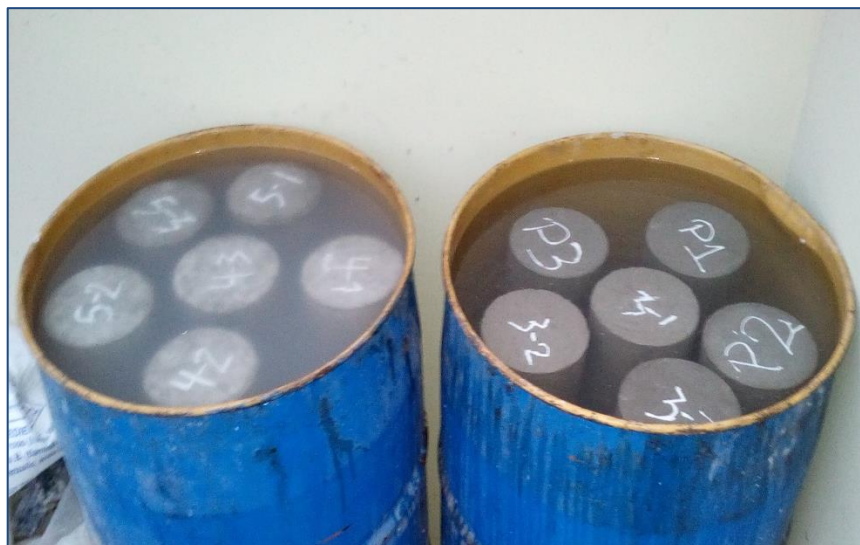
Figura 35: Curado de probetas (ASTM C-31)
