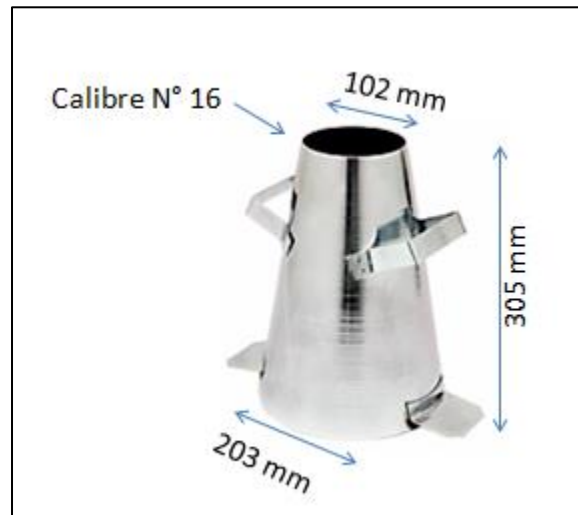
Figura 09: Molde para el ensayo de Asentamiento.
