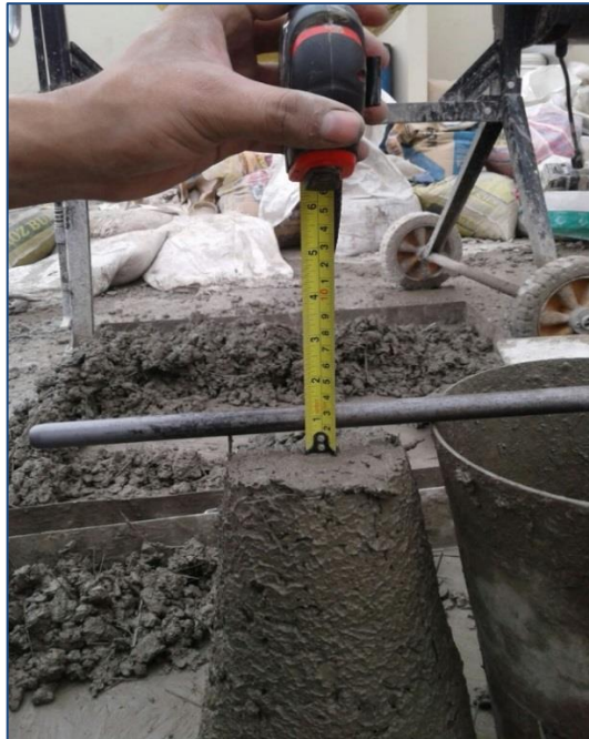
Figura 32: Ensayo de Asentamiento en el Concreto, con 4 kg/m 3 de fibra (ASTM C-143)
