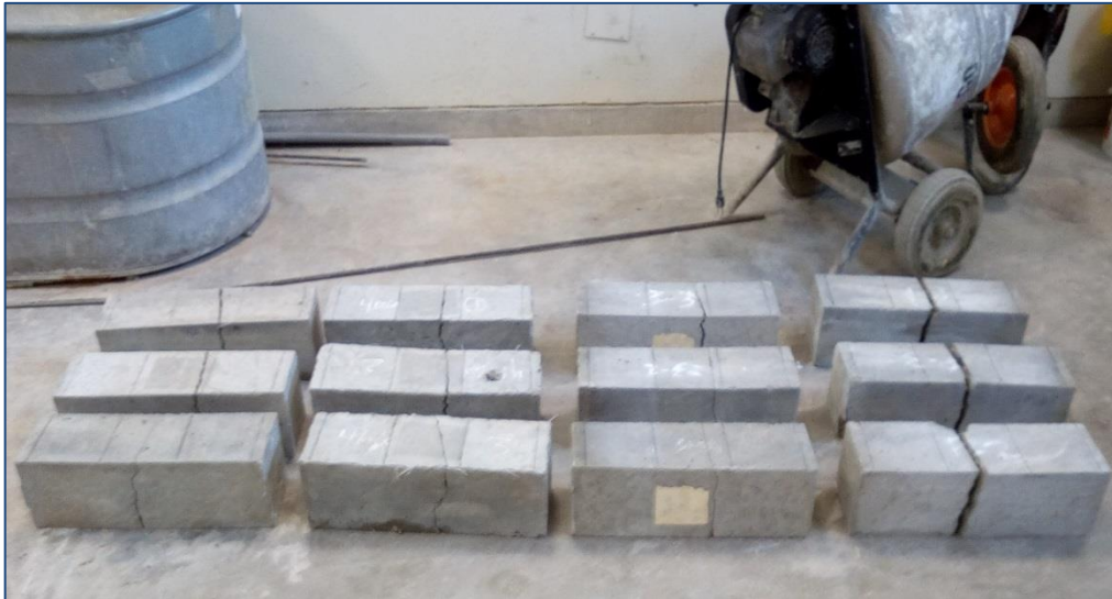
Figura 42: Probetas ya ensayadas a Flexión (ASTM C-78)
