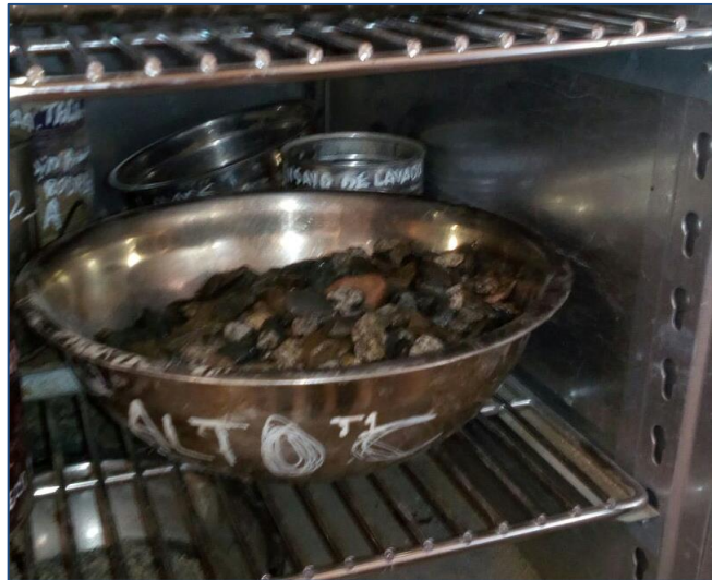
Figura 24: Ensayo de Contenido de Humedad Evaporable (ASTM C-566)
