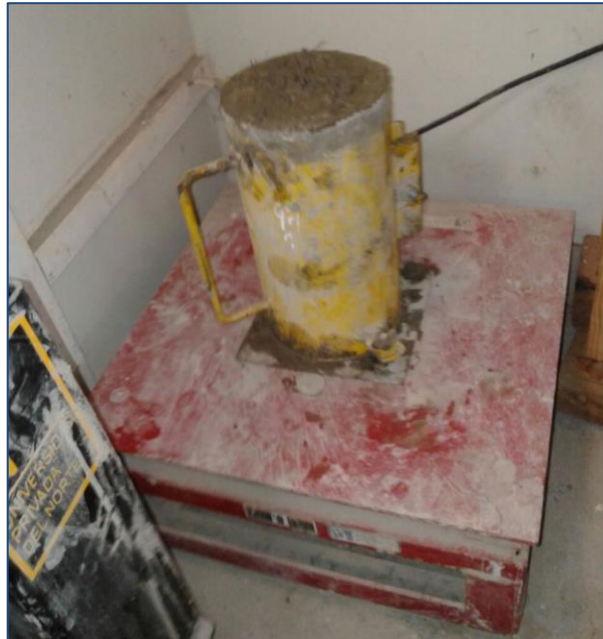
Figura 34: Llenado de moldes de 15 cm x 30 cm (ASTM C-31)
