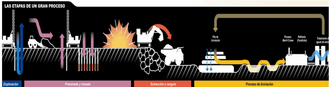
Figura 40. Proceso productivo del oro RETIRA1. Fuente: www.yanacocha.com
