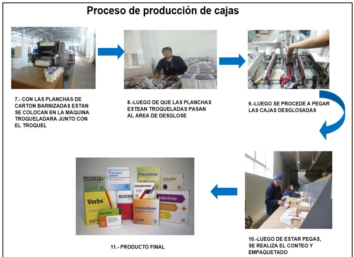
Figura 10. Modelos de procesos de impresión II (creación propia). Se muestra el proceso que se tiene que realizar para impresión de cajas.
