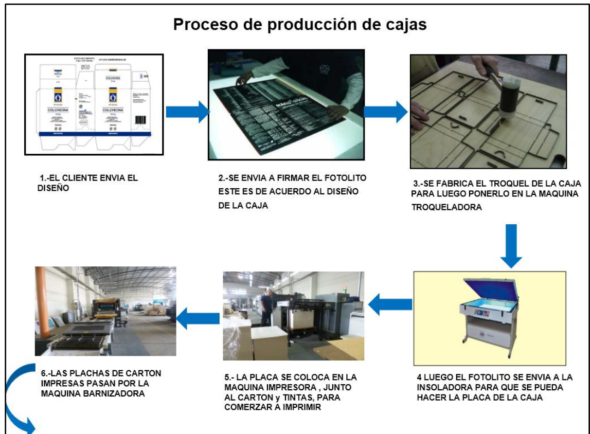
Figura 9. Modelos de procesos de impresión I (creación propia). Se muestra el proceso que se tiene que realizar para impresión de cajas.
