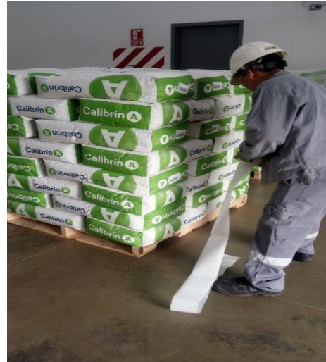
Figura n°3.6 Pegado de etiqueta de código de barra a todos los sacos recibidos
