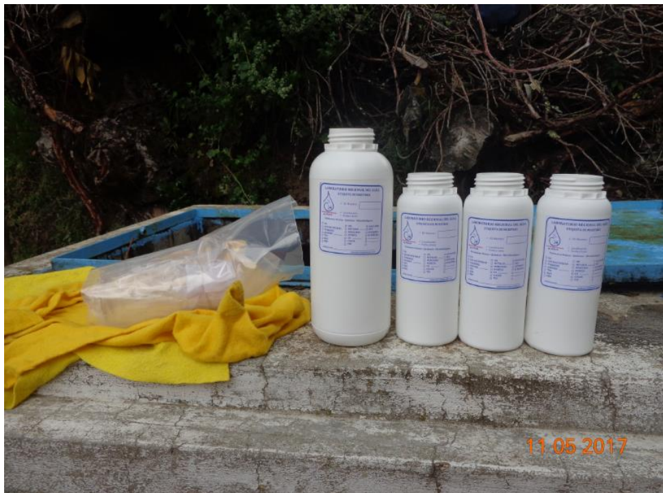
Figura nº. 44: Frascos de laboratorio para toma de muestra en cámara de reunión.
