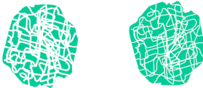
Figura nº. 2: Macroporos y mesoporos en los gránulos de carbón activado.
