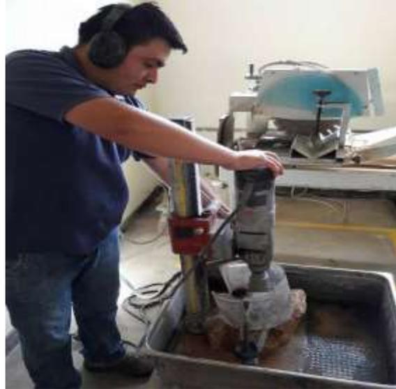
**Foto 5: Preparación de la probeta con el uso del equipo extractor de muestras**
