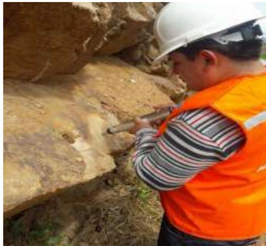
En campo se procedió a realizar el cálculo aleatorio del JCS. Para obtener los valores se ha trabajado con el ábaco que correlaciona la dirección de aplicación del Martillo de Schmidt y la densidad de la roca analizada para finalmente calcular la resistencia a la compresión unidimensional en Mpa. (Ver Figura 20)
