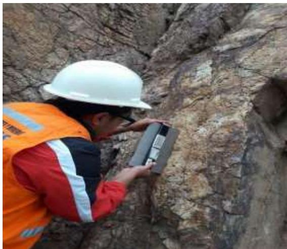
En campo se procedió a realizar el cálculo aleatorio del JRC. Para obtener los valores se ha trabajado con el ábaco de la figura 21.
