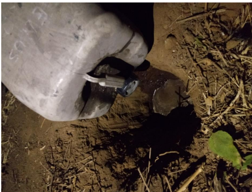
Fotografía 12. Saturación del suelo para test de percolación In Situ
