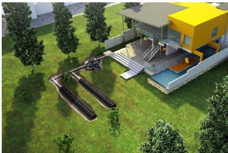
Figura 4. Sistema de alcantarillado in situ
