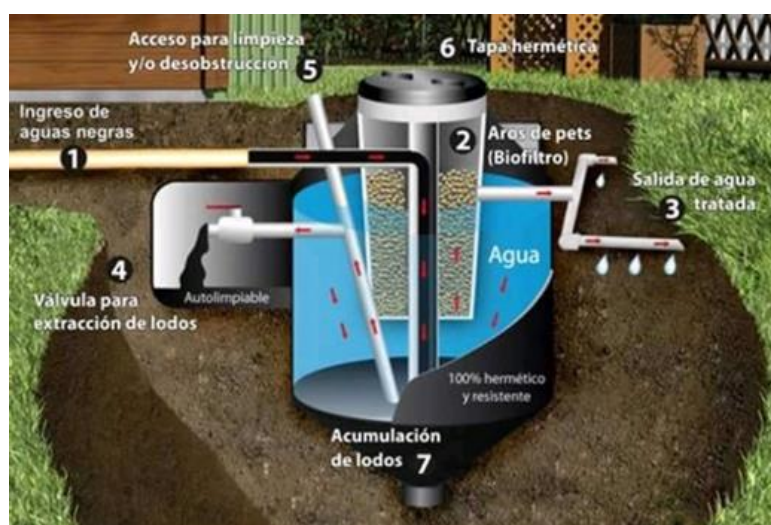
Figura 14. Funcionamiento del biodigestor
