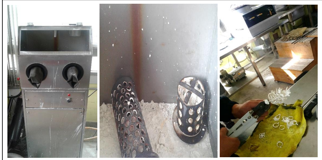
Gráfico n° 4.18 Retiro del revestimiento y corte de piezas casteadas.
