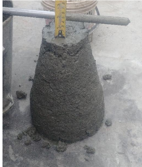
Figura N° 41. Revenimiento de mezcla control con relación a/c 0.40
