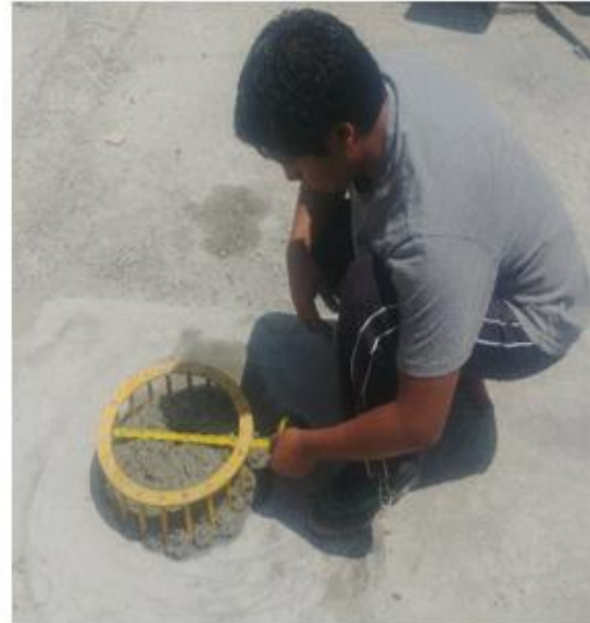
(b) Extensión de flujo a través del anillo J.
