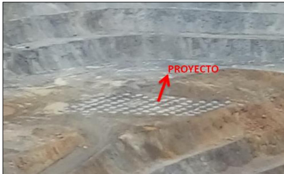
Figura 39: Imagen pre voladura P 3720-044. Fuente: Oficina de asistencia técnica EXSA – Cerro Corona, 2017.
