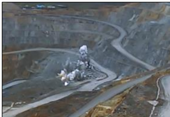
Figura 29: Imágenes de la NO presencia de gases nitrosos.
