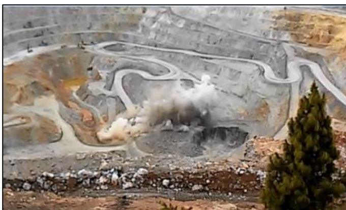
Figura 104: No presencia de gases nitrosos.
