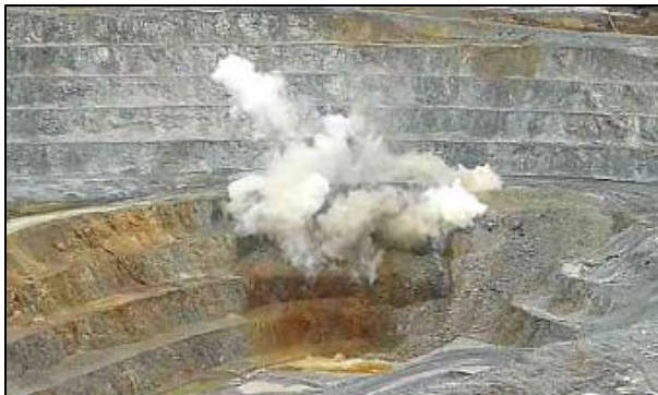
Figura 16: Imágenes de la NO presencia de gases nitrosos.
