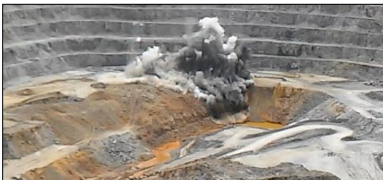
Figura 90: No presencia de gases nitrosos.
