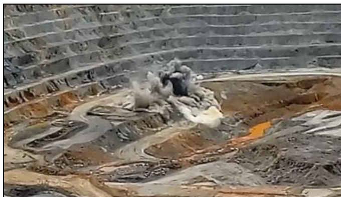
Figura 83: No presencia de gases nitrosos.
