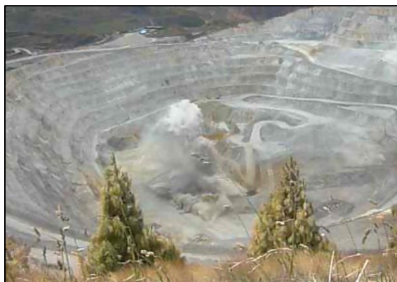
Figura 111: No presencia de gases nitrosos.
