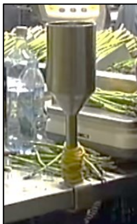
Figura N° 23 Herramienta de atado fijada
