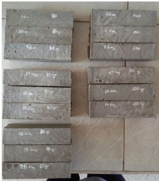
Figura N°17. Ensayo de resistencia a la Flexión
