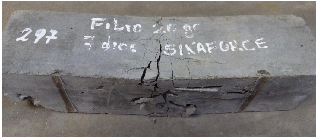
Figura N°13. Probeta de flexión, de mortero reforzado Con SIKAFORCE PP48
