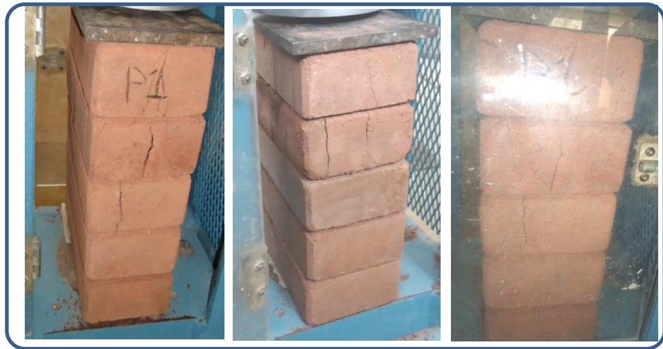
Figura n.º 28 Falla de las pilas por desplazamiento vertical
