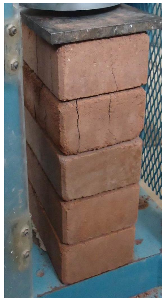
Anexo n.º 11 Falla en forma vertical a las pilas (f'm)
