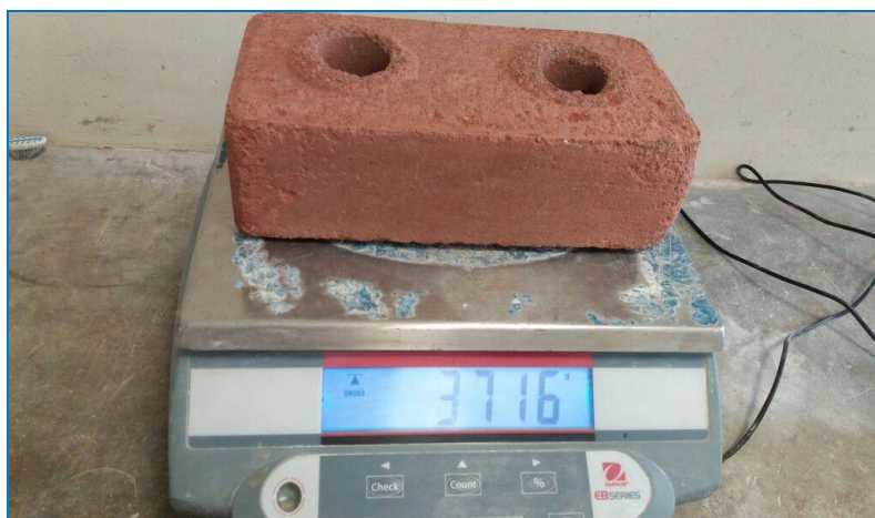
Figura n.º 25 Densidad del Ladrillo
