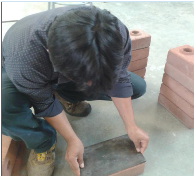
Figura n.º 26 Ladrillos que serán sometidos a compresión
