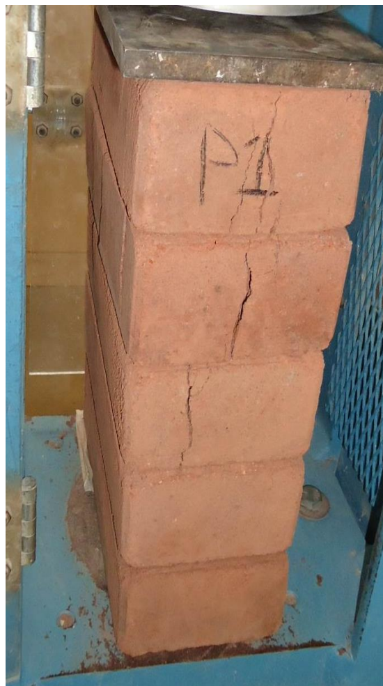
Anexo n.º 11 Falla en forma vertical a las pilas (f'm)
