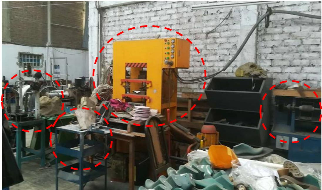
Imagen n° 3: Máquinas mal ubicadas
