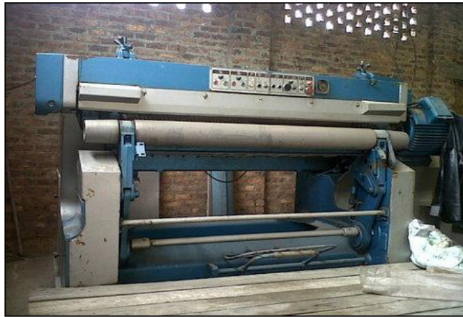
Figura N° 19: Máquina rebajadora de mantas - 1
