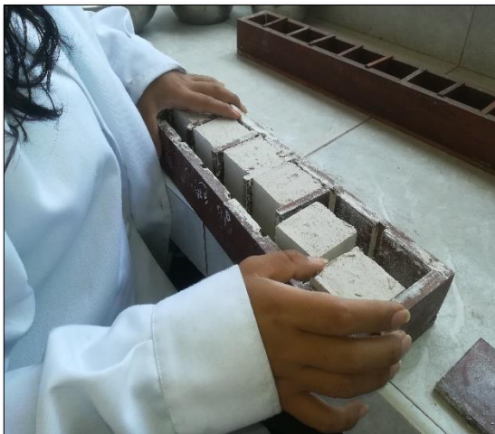
Figura 26: Conformación y desmolde de probetas
