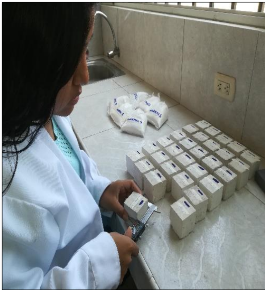
Figura 28: Medida de contracción del mortero
