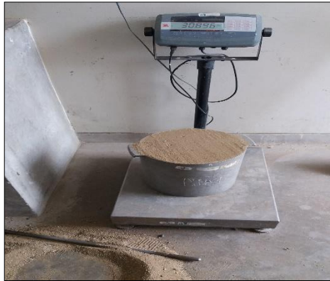
Figura 25: Determinación del peso unitario suelto y compacto de la arena
