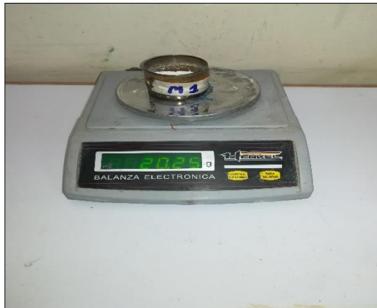
Figura 23: Peso de la humedad de la cal
