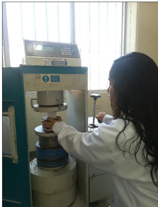
Figura 32: Ensayo de resistencia a la compresión
