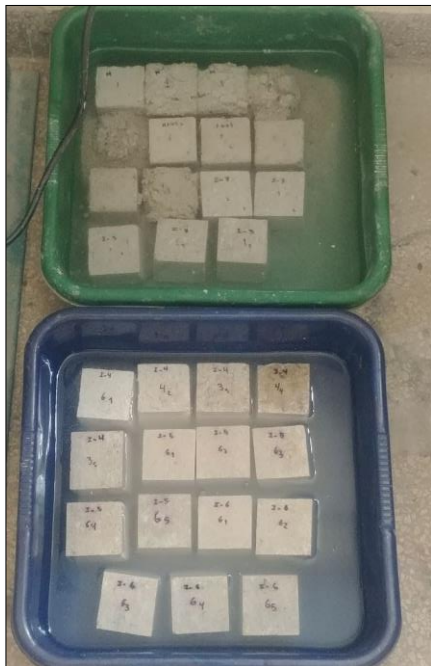
Figura 30: Probetas sumergidas en agua para el ensayo de densidad y absorción
