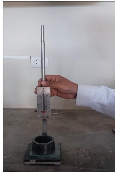
Figura 29: Aguja de Vicat para el fraguado
