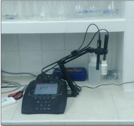
Figura 33: Medición de la conductividad
