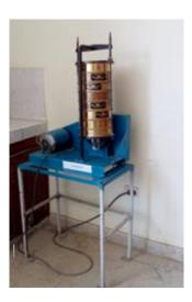
Figura 27: Análisis granulométrico del agregado fino, tamices en la mesa vibradora.
