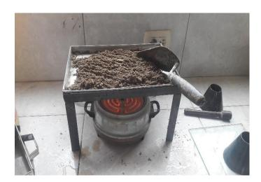
Figura 28: Peso específico y absorción por método de la fiola.
