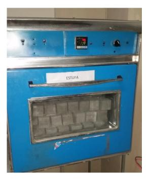
Figura 31: Peso seco para ensayo de absorción.
