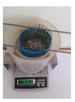
Figura 30: Peso saturado y sumergido para ensayo de absorción.
