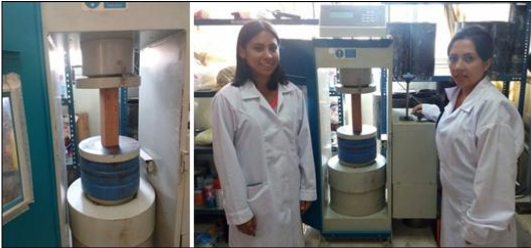
Figura N° 37: Ensayo a compresión paralela a la fibra
