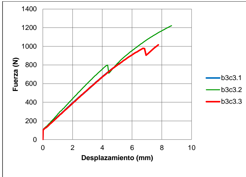
Figura N° 50: Ensayo de madera catahua circular (2mm x 2mm x 38 mm)
