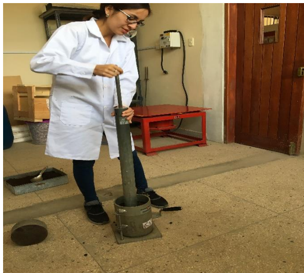
Se compacta el material en el ensayo de Proctor Modificado
