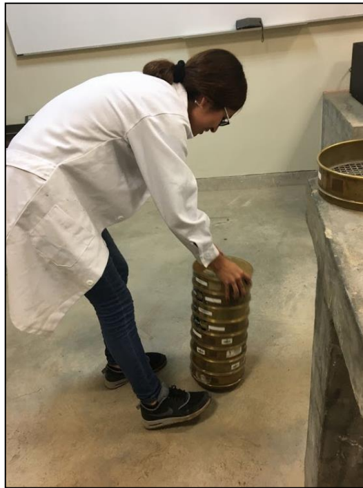
Figura n.º 8. Ensayo de granulometría por tamizado
