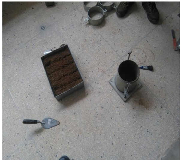
Se divide el suelo en 5 capas en el ensayo de Proctor Modificado
