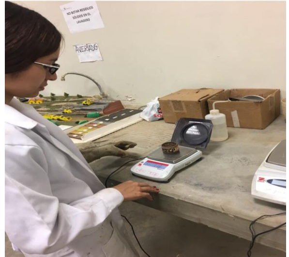
Pesando las muestras para realizar el ensayo de contenido de humedad
