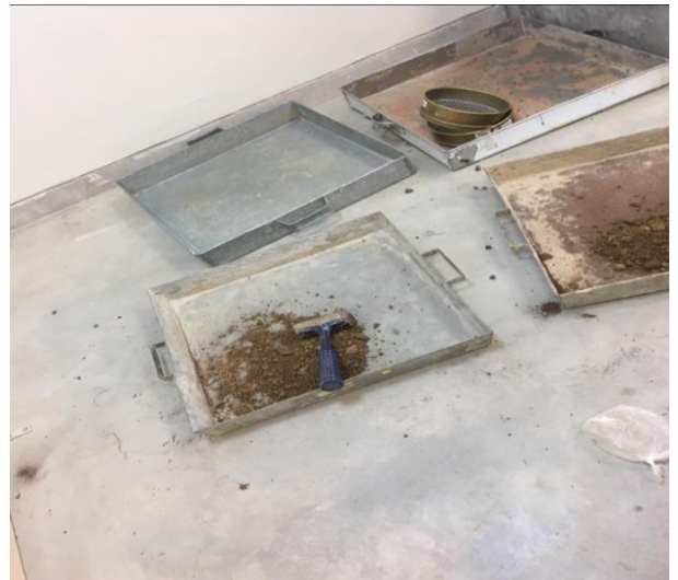
Disolvemos los grumos que se formaron en nuestro suelo para poder realizar el ensayo de granulometría
