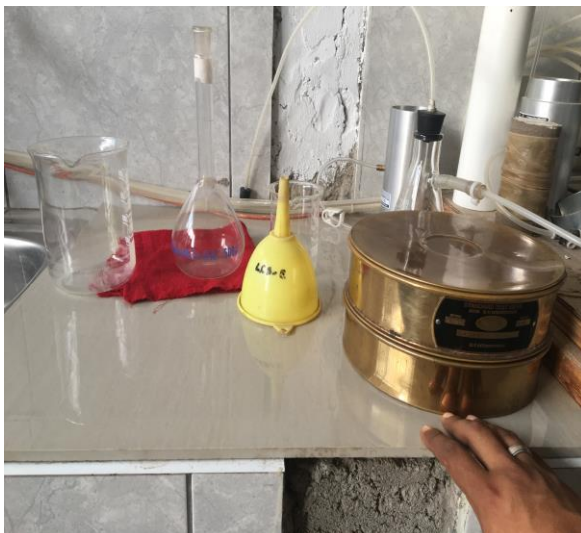
Instrumentos de laboratorio que se van a utilizar para realizar el ensayo de Gravedad Específica
