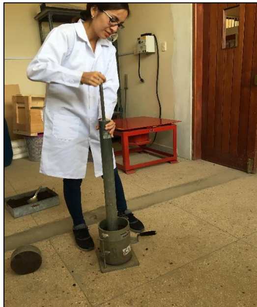
Figura n.º 12. Ensayo Proctor Modificado
