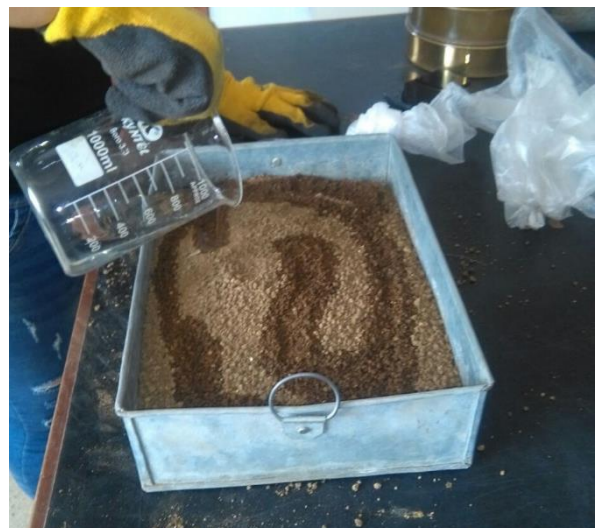
Preparando material para el ensayo de CBR
