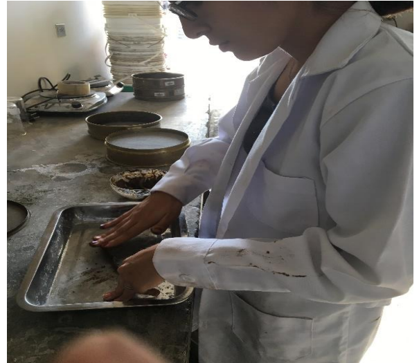
Realizando el ensayo de Límite Plástico
