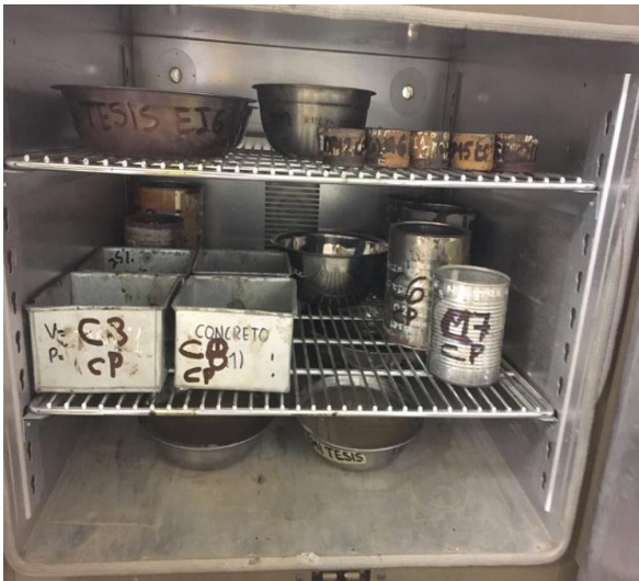
Muestras en el horno para calcular el contenido de humedad
