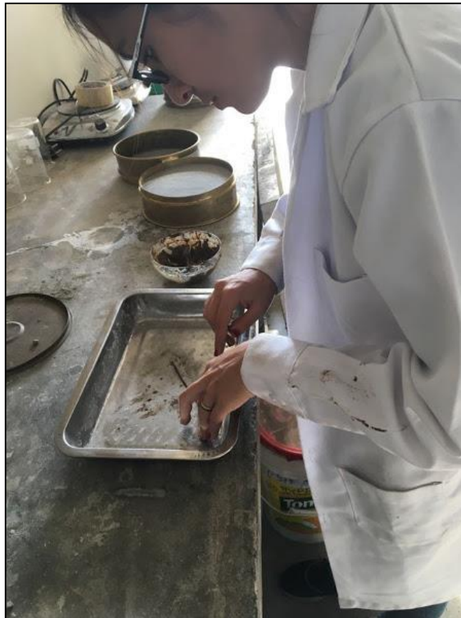
Figura n.º 10. Ensayo de límite plástico
