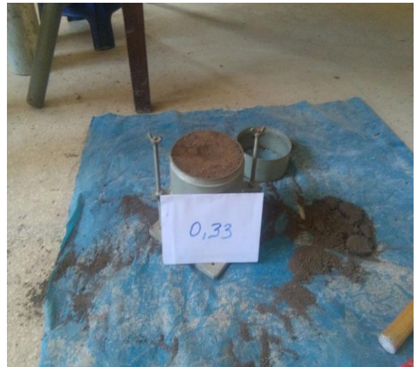
Suelo con la adición de 0.33 L/m 3 de aditivo PROES
