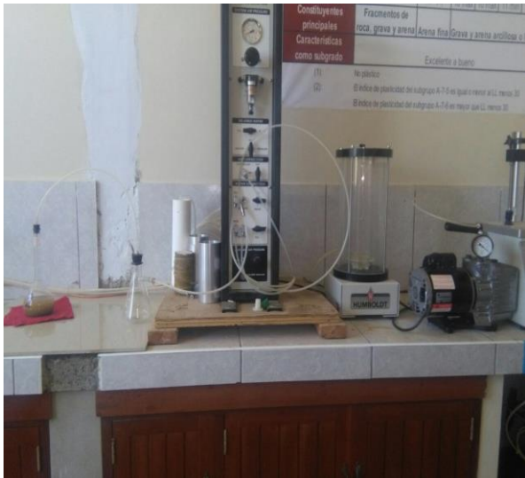
Sometiendo la calicata 1 a la bomba de vacíos
