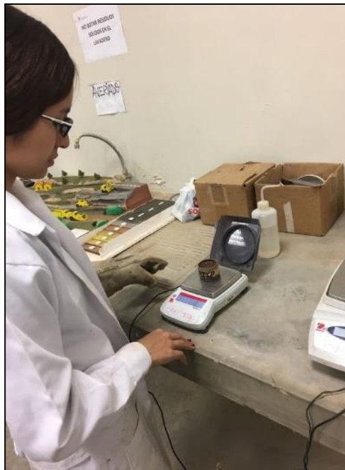
Figura n.º 11. Ensayo de Contenido de Humedad
