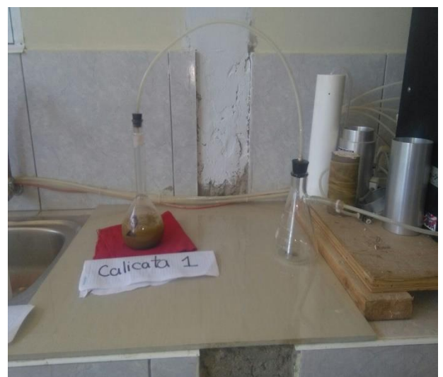
Calicata número 1 para hallar su gravedad específica
