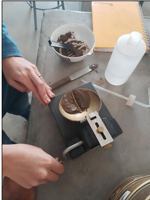
Figura n.º 9. Ensayo de límite líquido
