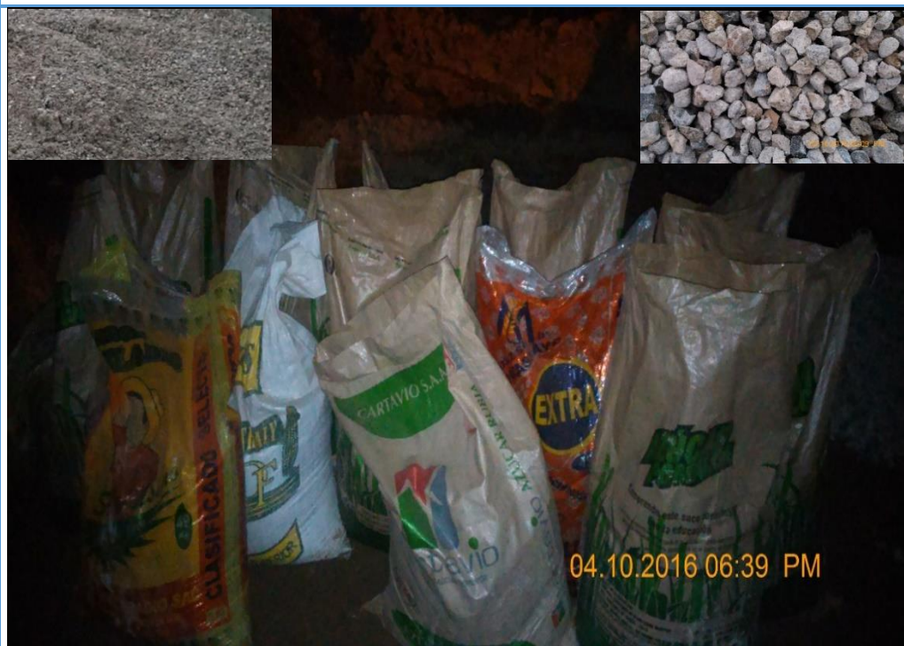
Figura 3.10: Material listo para ser trasladado en costales. (agregado grueso de 1" y agregado fino)
