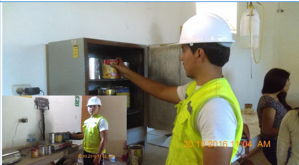
Figura 3.13: Realizando ensayo de contenido de humedad de los agregados.
