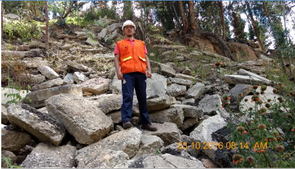
Figura 3.5: Recolección del concreto reciclado de pavimento rígido, arrojado como desmonte, ubicado a 10 min de la ciudad de Cajamarca, en movilidad.
