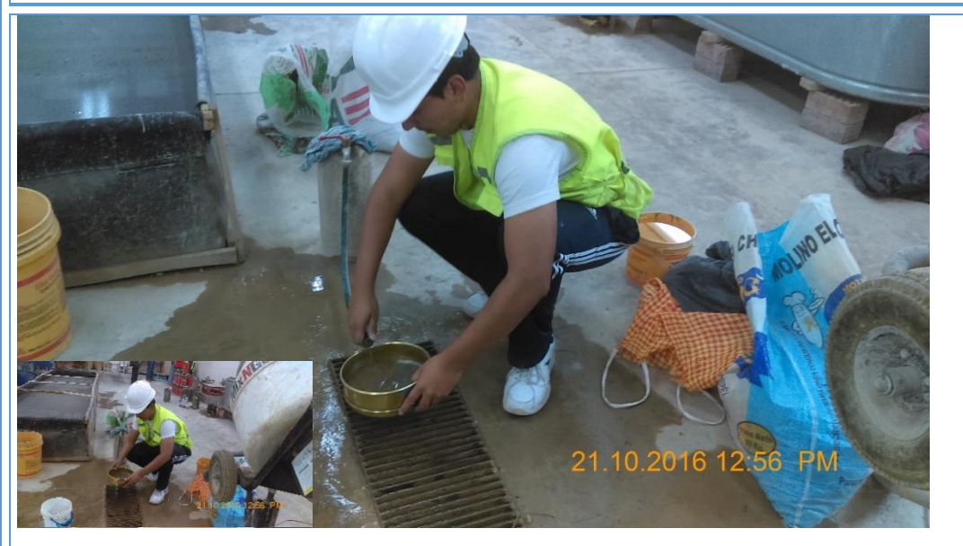
Figura 3.16: Realizando ensayo de cantidad de material fino que pasa por el tamiz N°200.
