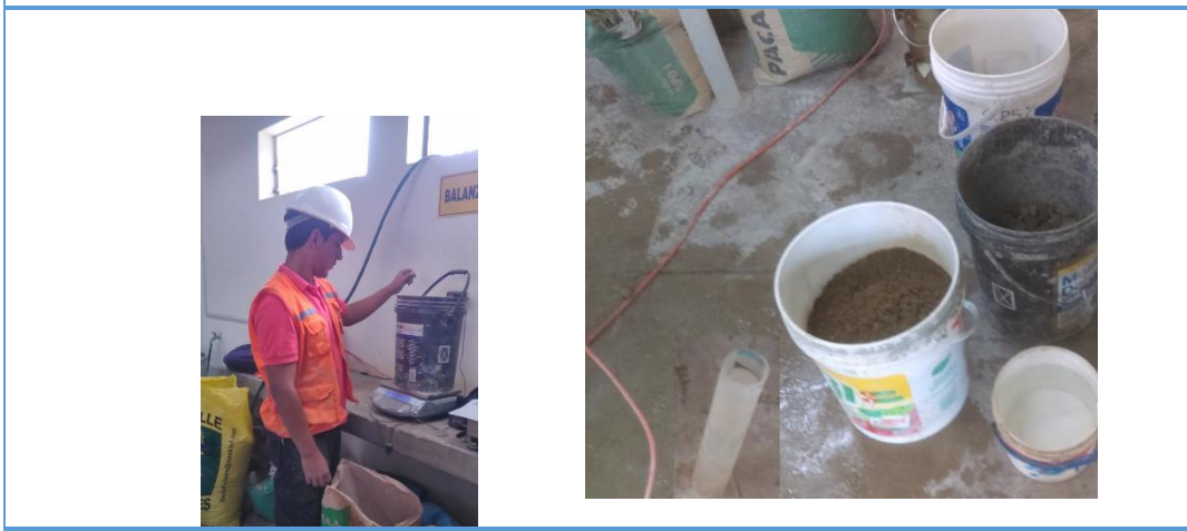
Figura 3.18: Peso de materiales correspondiente a su diseño para realizar los especímenes a los 28, 14 y 7 días.
