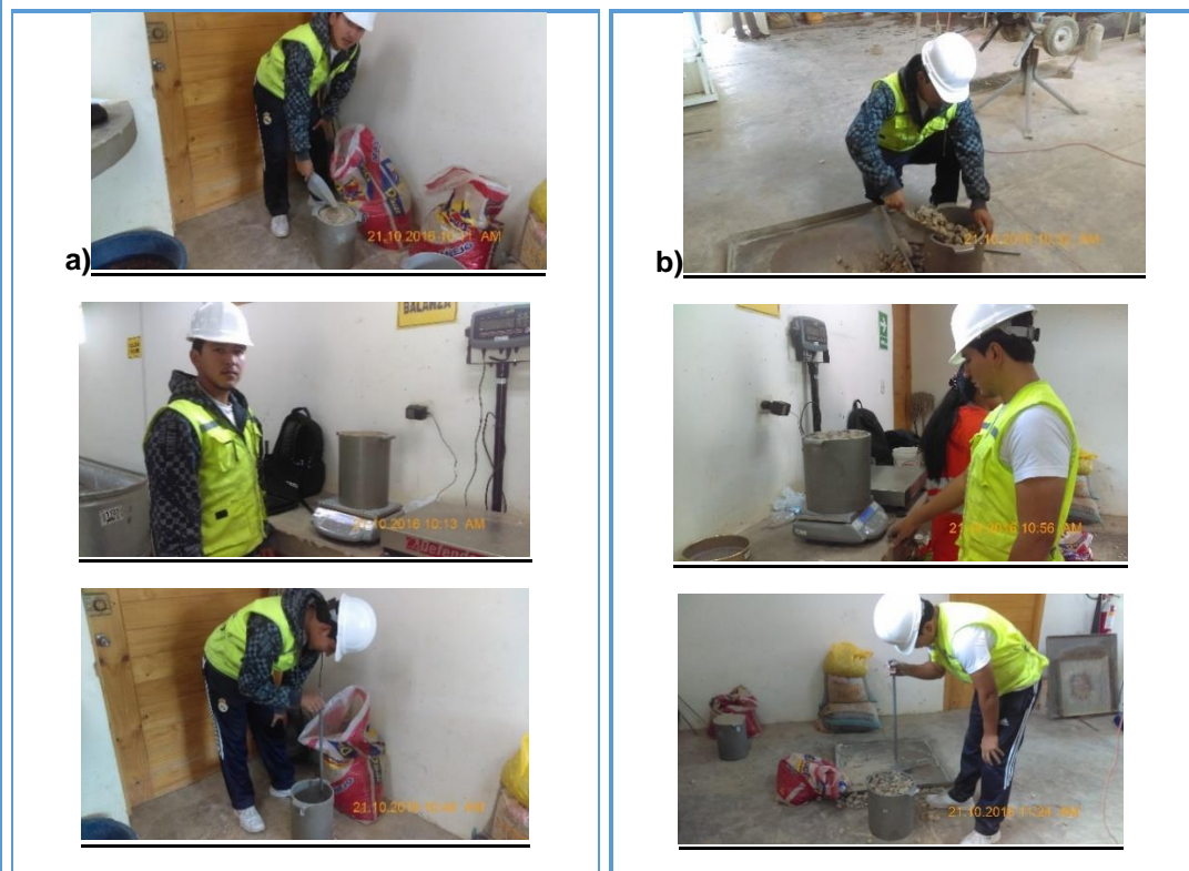
Figura 3.15: Realizando ensayo de peso unitario de los agregados: a) Agregado fino y b) Agregado grueso.
