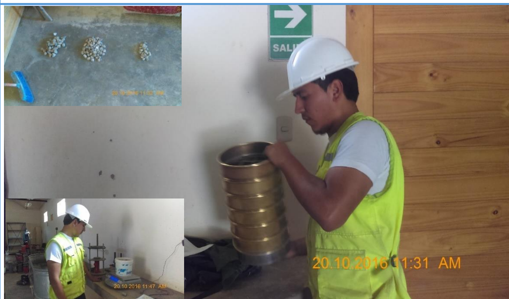
Figura 3.14: Realizando ensayo de granulometría de los agregados.
