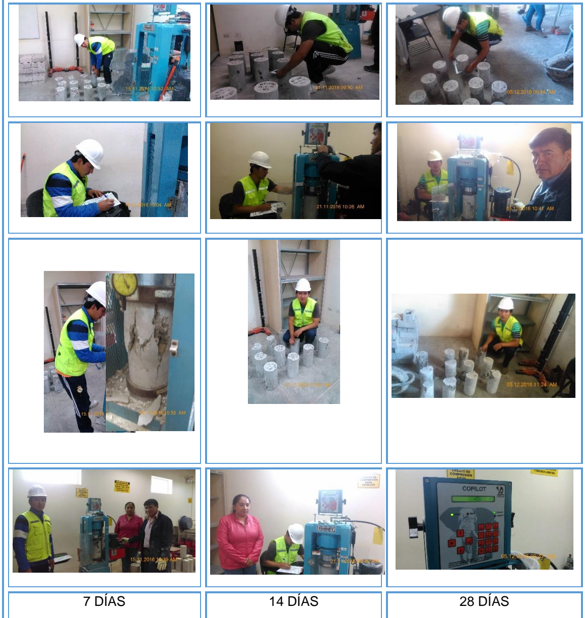
Figura 3.21: Midiendo el diámetro y la altura de cada probeta / Realizando el ensayo de resistencia a compresión de cada probeta / Falla vertical en probeta / Tomando datos de la deformación en la máquina a compresión de cada probeta mediante la supervisión de la asesora Ingeniera Irene Ravines Azañero y encargado de laboratorio Víctor Cuzco Minchán.
