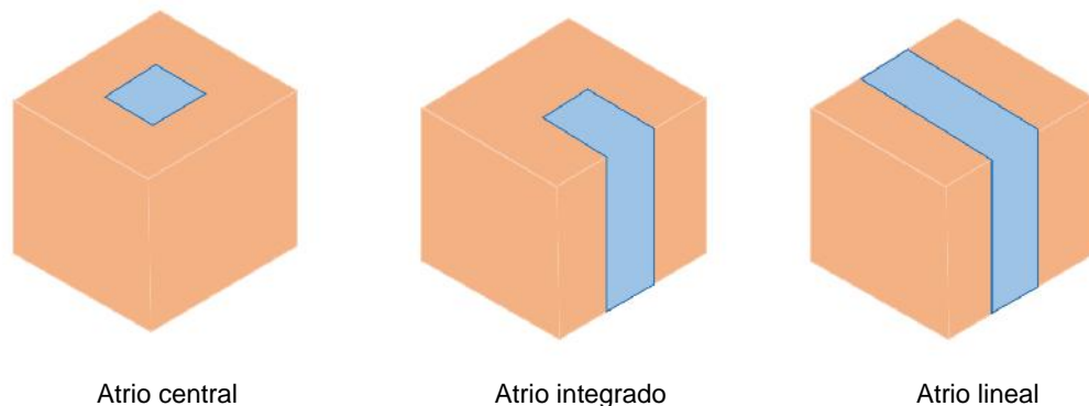
Figura 11: Esquemas de organización del atrio en una edificación.
