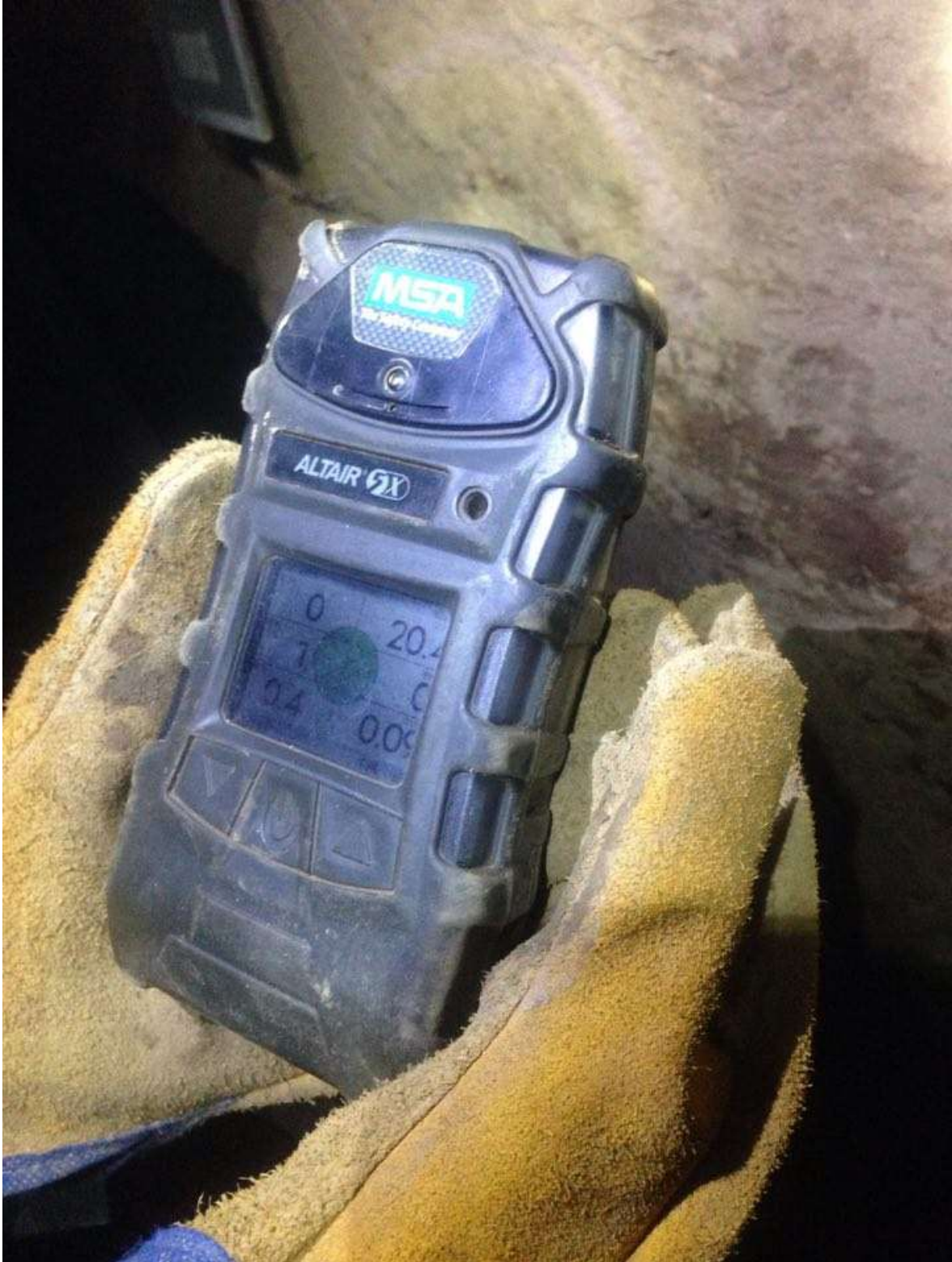
Fotografía 6: equipo Detector Multigas Altair 5x
