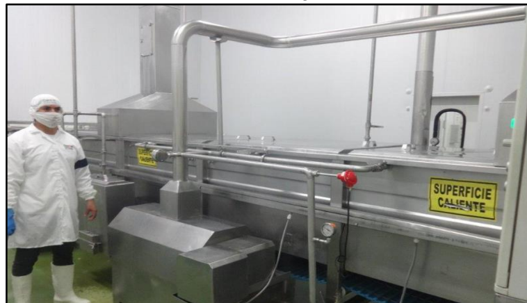
Figura 4: Desinfección Continua en el Blanching
