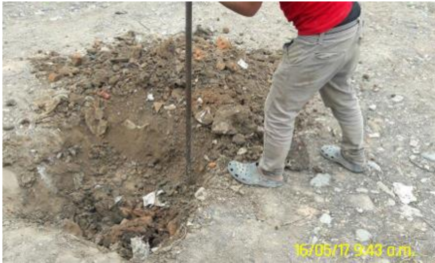
Fotografía N°1: Realización de la calicata N°1
