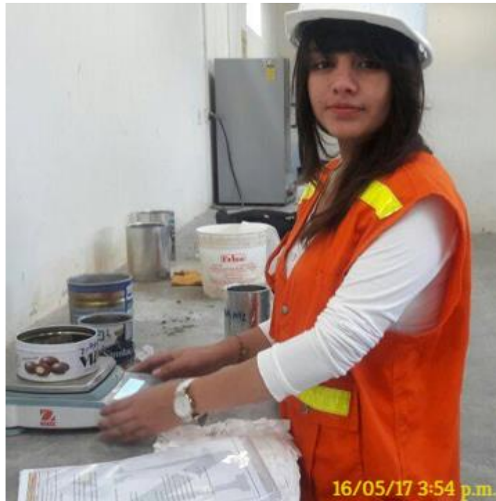
Fotografía N°5: Ensayo de contenido de humedad
