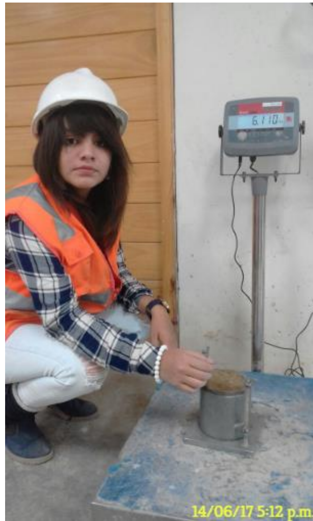
Fotografía N°15: Peso de muestra para proctor.
