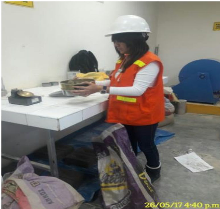
Fotografía N°12: Tamizado de material para límites de atterberg
