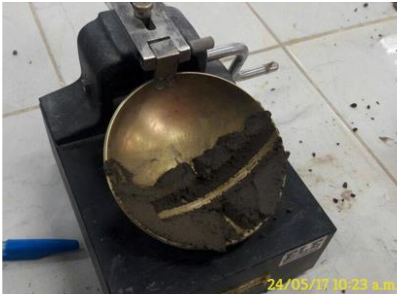
Fotografía N°9: Ensayo de limites en la Casagrande
