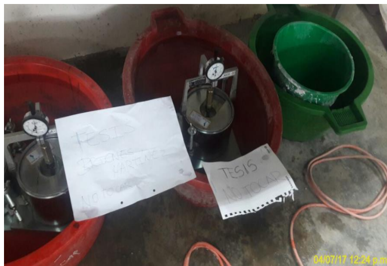
Fotografía N°16: Ensayo de CBR
