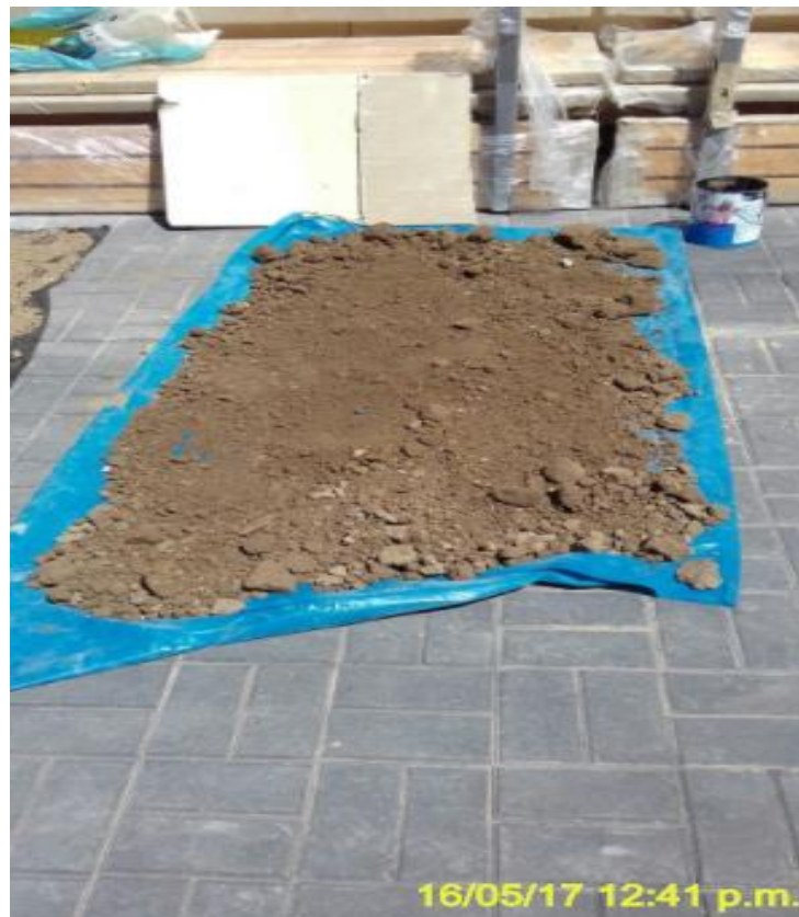
Fotografía N°4: Secado de material
