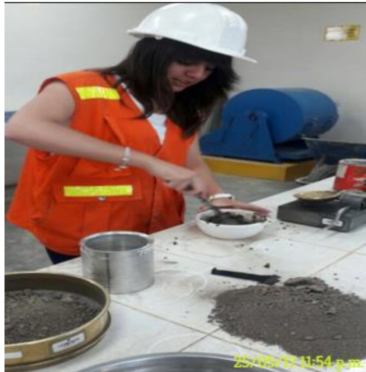
Fotografía N° 6: Realización del ensayo de limites de atterberg
